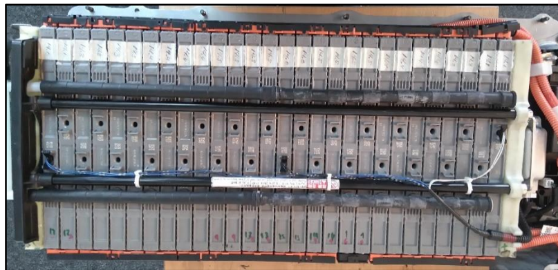
Figura 102: Batería con celdas cambiadas
