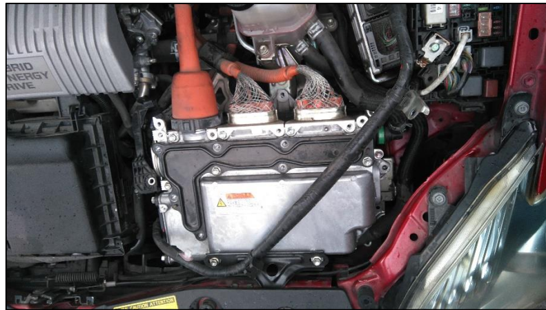
Figura 29: Ubicación del inversor
