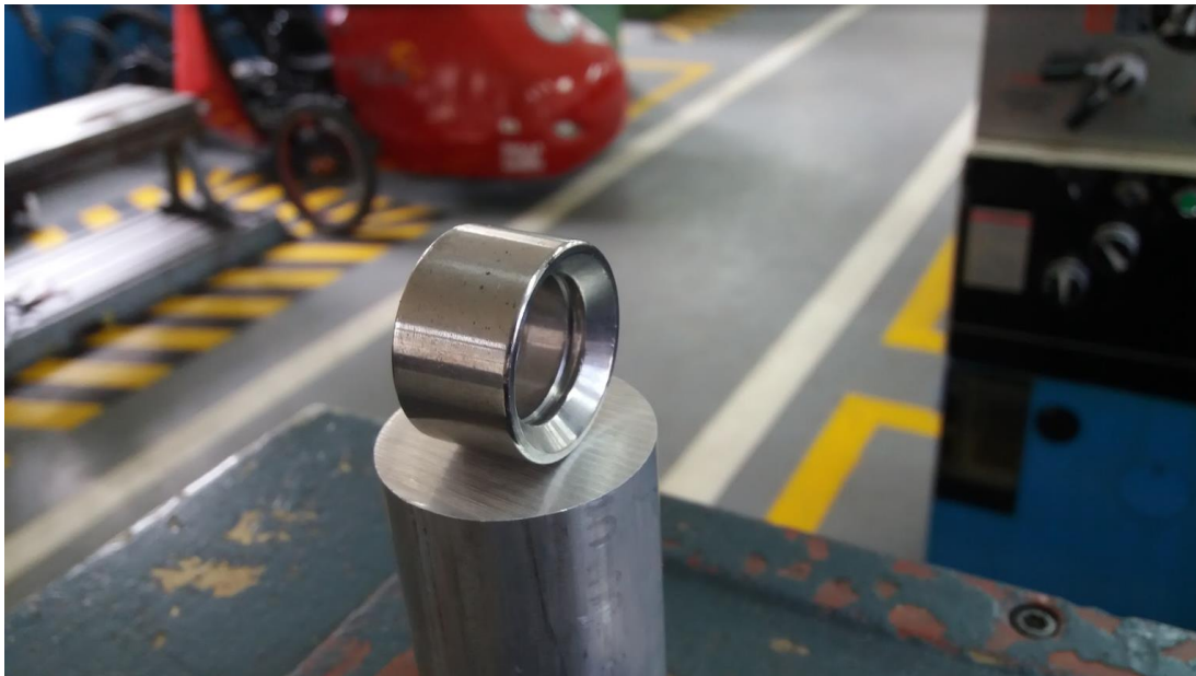
Figura 171 Carcasa 13/16" en acero de la marca PRO-WERKS
