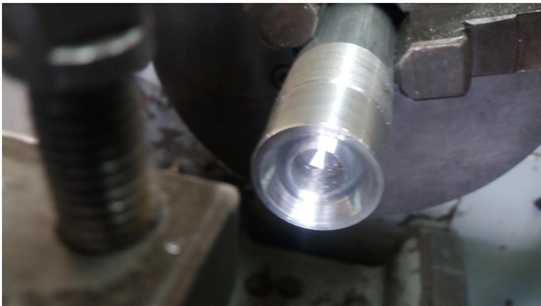
Figura 172 Carcasa 13/16" construida en aluminio 7075-T6.
