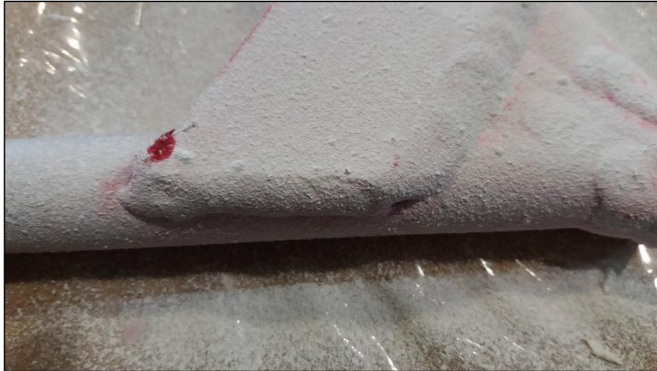
Figura 192 Revelación de imperfecciones en la mesa superior
