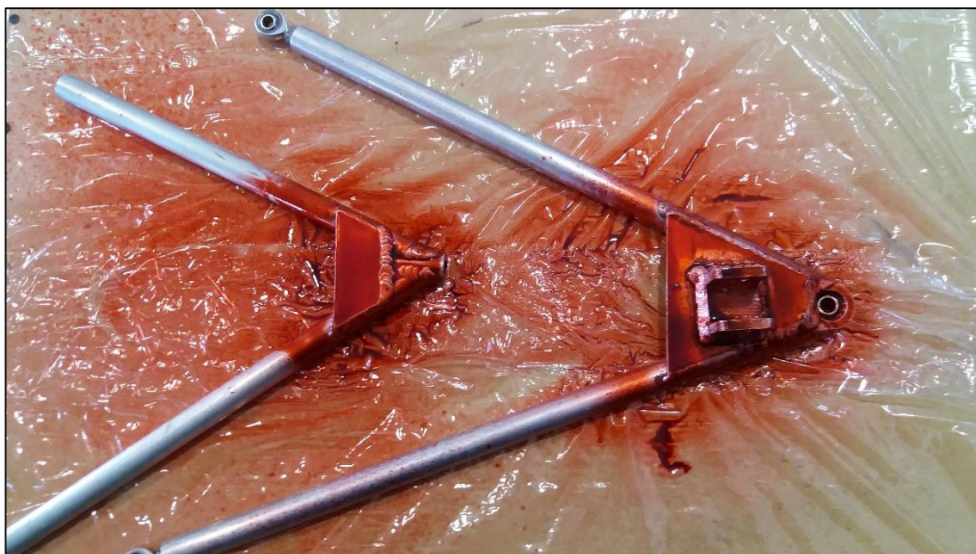
Figura 189 Aplicación del líquido penetrante sobre las mesas
