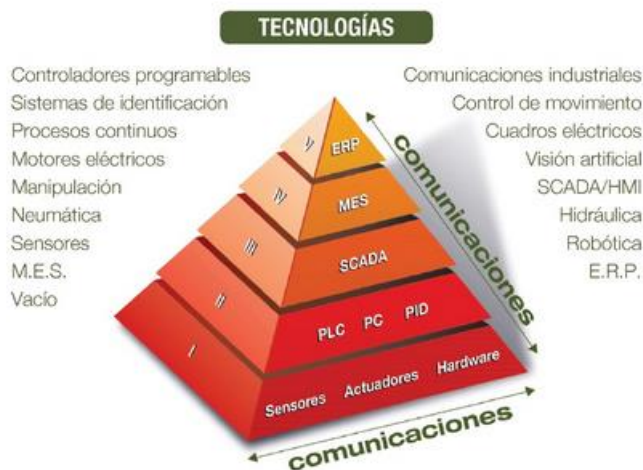
Figura 1 Pirámide de Automatización
