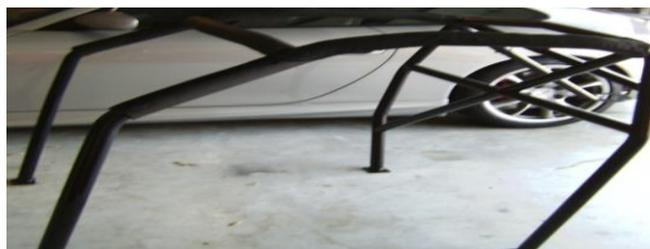
**Figura 50. Jaula de seguridad roll bar**
