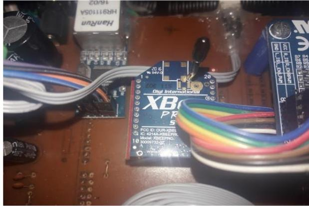
**Figura 101. Módulo XBEE s1 pro, tarjeta de control**
