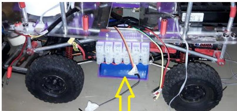
**Figura 97. Montaje de la batería del sistema electrónico**
