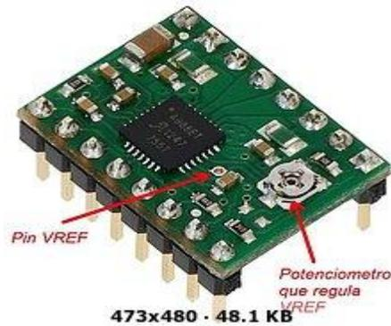
**Figura 67. Calibración del driver A4988.**
