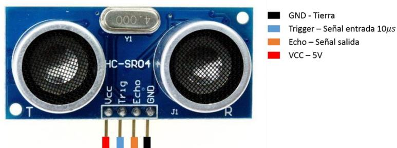
**Figura 20. Pines del sensor HC SR04**
