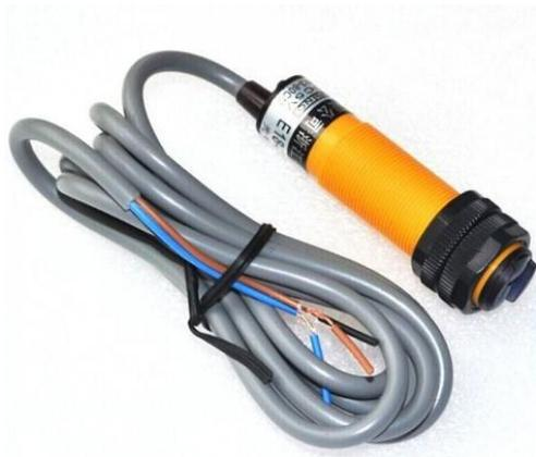
**Figura 35. Sensor infrarrojo E18 D80NK**
