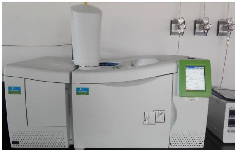
**Figura 18: Cromatógrafo de gases acoplado al espectrómetro de masas**
