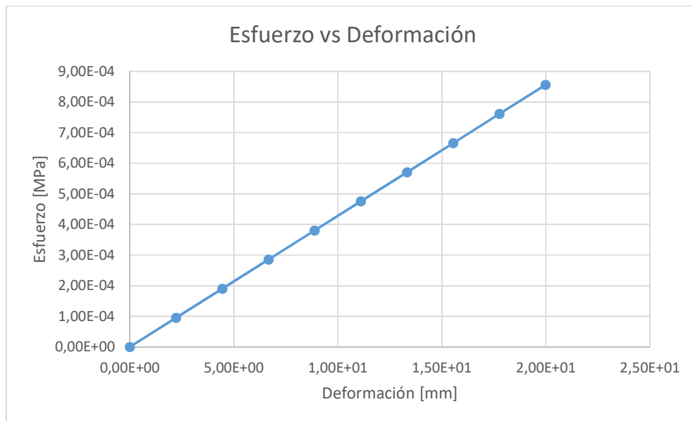
Figura 91. Diagrama Esfuerzo Deformación producidos en la tibia para un peso de 300 kg
