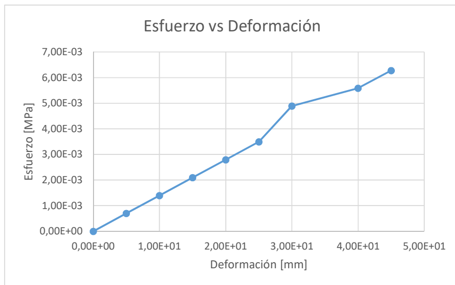
Figura 81. Diagrama Esfuerzo Deformación para un peso de 300 kg
