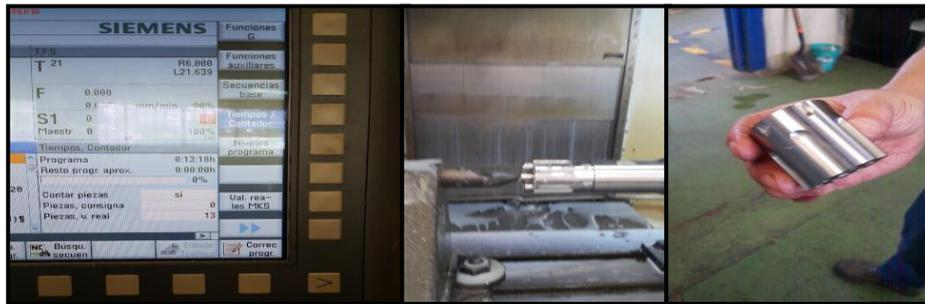
*Figura 39.* Simulación y elaboración de prototipo de tambor de revolver
