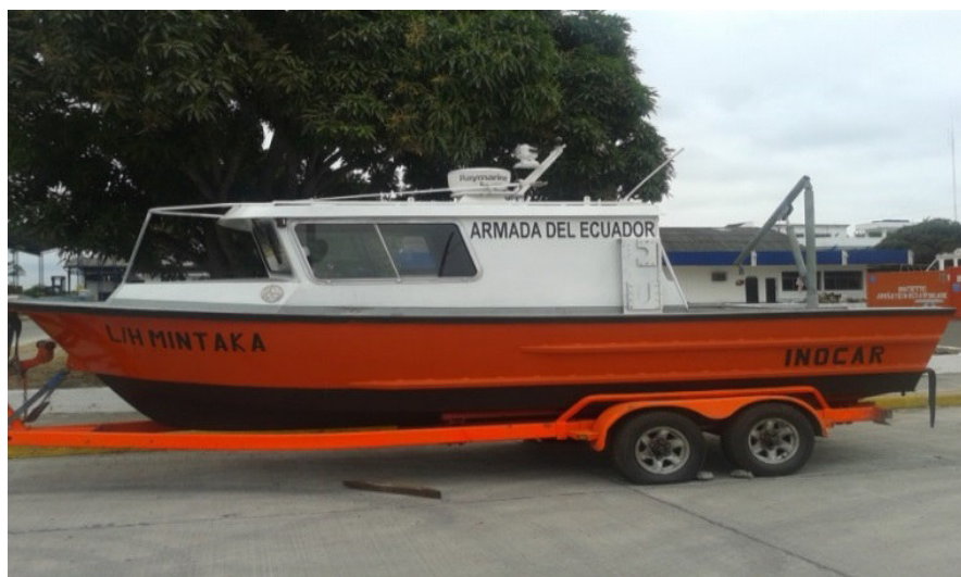
Figura 1 Lancha hidrográfica tipo tiburón Fuente: Instituto Oceanográfico de la Armada
