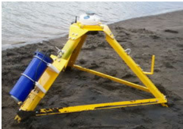
Figura 20 Correntómetro Fuente: Instituto Oceanográfico de la Armada
