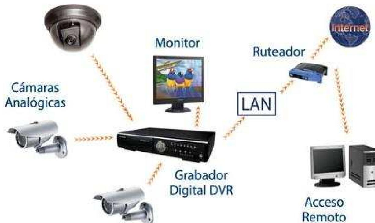
**Figura 2 Componentes de un sistema CCTV**
