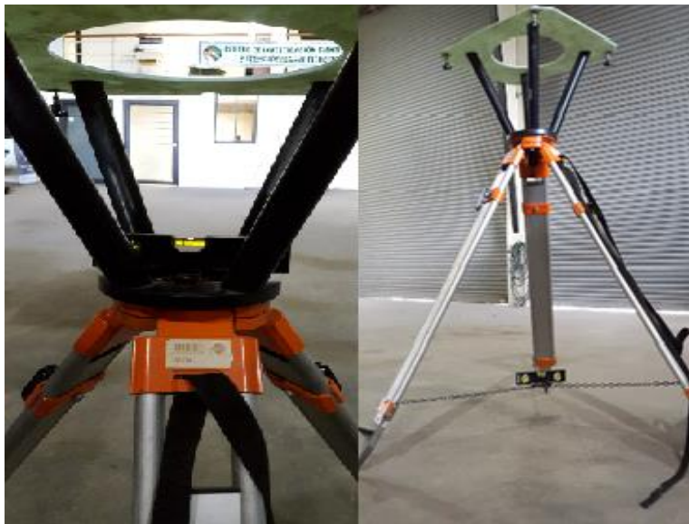
Figura. 25. Nivelación del trípode.
