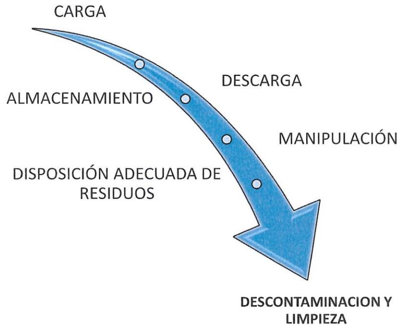
**Figura 27 Procesos en manipulación de combustible**
