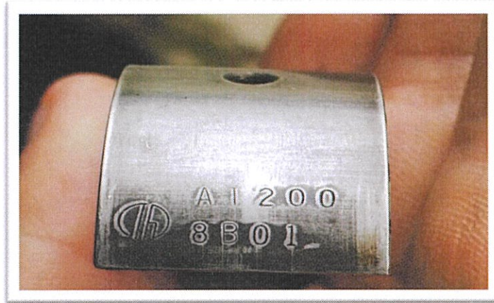
Figura 0.9. Chapas de las bielas Fuente: Laboratorio de Maquinaria Naval Elaborado por: Alex Armijos J.
