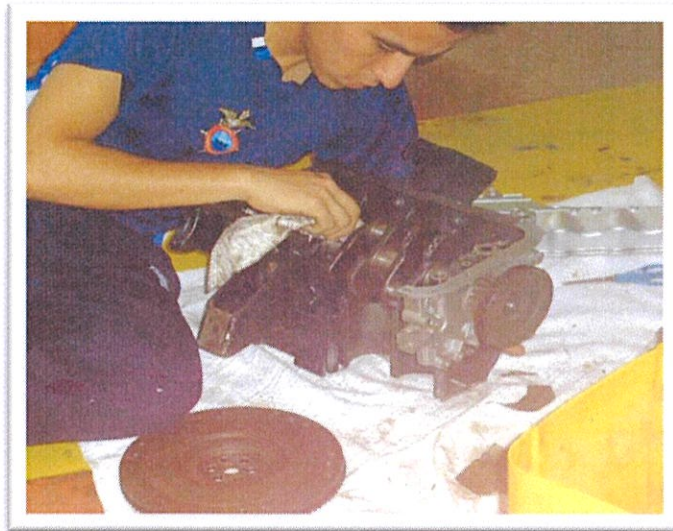
Figura 0.4. Limpieza del cigüeñal del motor Fuente: Laboratorio de Maquinaria Naval Elaborado por: Alex Armijos J.
