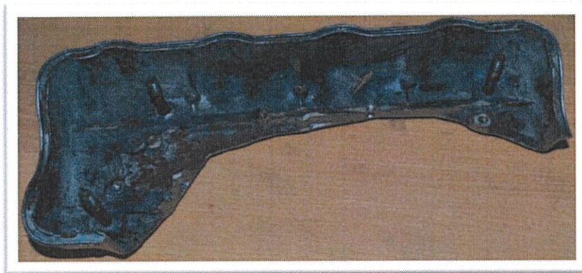
Figura 2.5. El Cárter Fuente: Laboratorio de Maquinaria Naval Elaborado por: Alex Armijos J.
