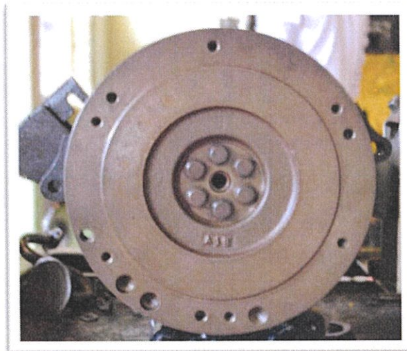
Figura 2.14. Volante de Inercia Fuente: Laboratorio de Maquinaria Naval Elaborado por: Alex Armijos J.
