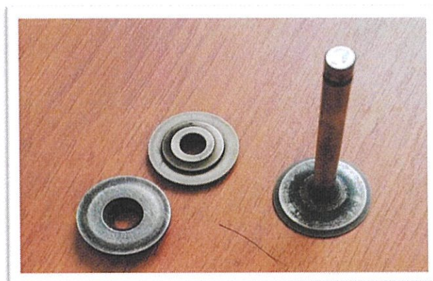
Figura 2.12. Válvulas Fuente: Laboratorio de Maquinaria Naval Elaborado por: Alex Armijos J.
