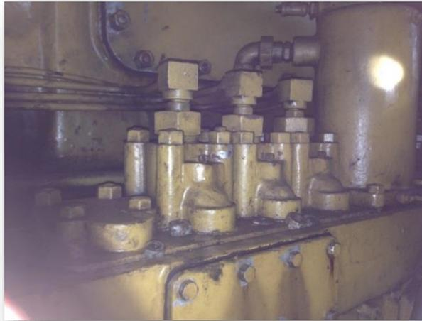
**Figura 2.12 Bombas de inyección**
