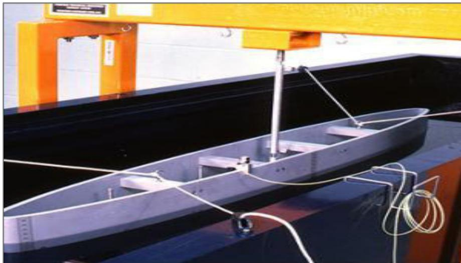
**Figura 4.9 Modelo de ensayo de vibraciones en naves**
