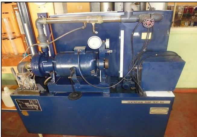
**Figura 2.8 Banco de prueba de la bomba centrífuga**
