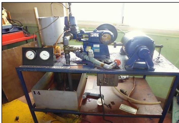
**Figura 2.7 Banco de prueba de la bomba de alternativa**
