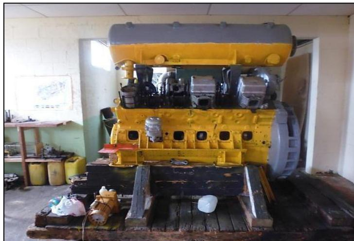
**Figura 4.11 ¾ de Maquina de un Motor MTU desmontado**
