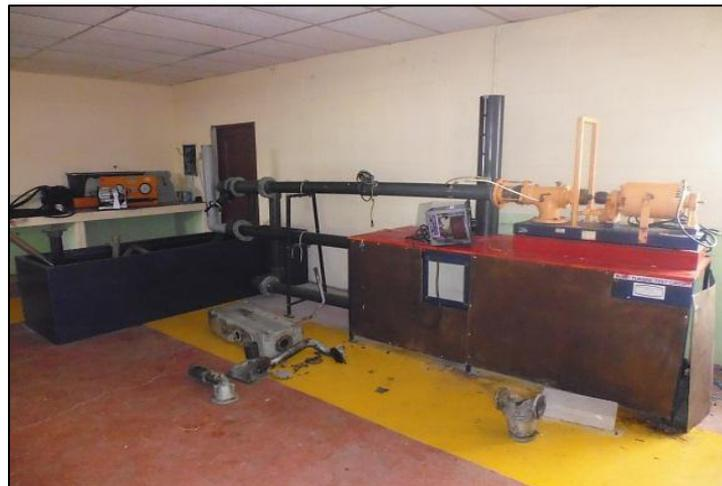
**Figura 2.12 Simulador de flujo de hélice de paso variable**
