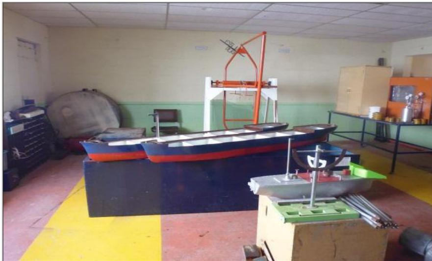
**Figura 4.8 Banco de pruebas de estabilidad estática de buques**
