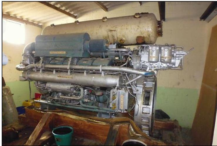
**Figura 4.10 Motor MTU de 4 tiempos de un submarino**
