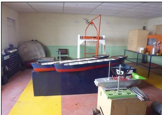
**Figura 2.5 Banco de pruebas de estabilidad estática de buques**
