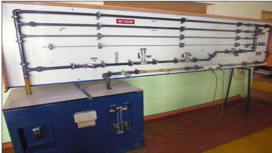
**Figura 4.5 Banco de pruebas para fricción de fluidos**
