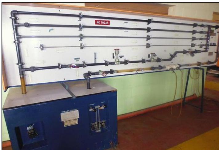
**Figura 2.6 Banco de pruebas para fricción de fluidos**
