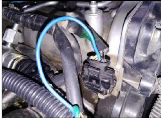
**Figura 25. Pin de señal del CMP**
