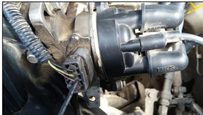
***Figura 30. Señal del distribuidor***
