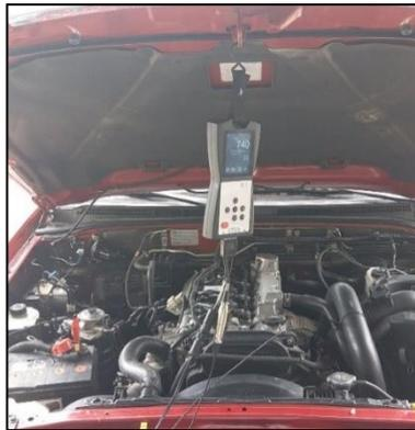
**Figura 40. Medidor de revoluciones y temperatura MGT-300 EVO**
