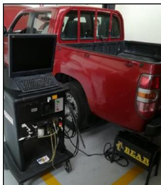
**Figura 41. Medición de Opacidad en el vehículo diésel**
