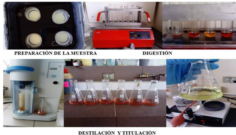
Figura 8 Determinación de proteína total
