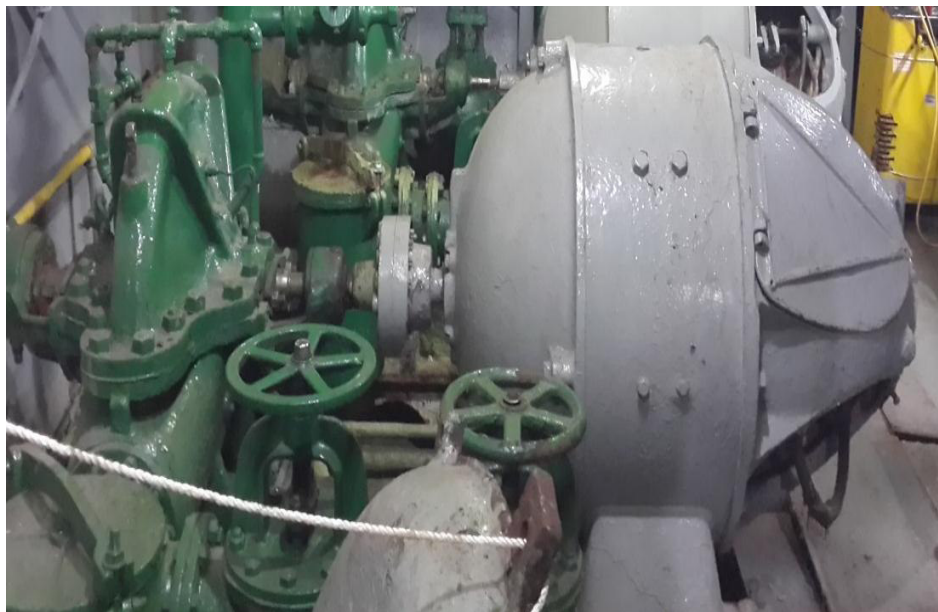
Figura 3.12 Fotografía de la bomba de salvataje P500 Fuente y elaborado por: Andrés Idrovo González
