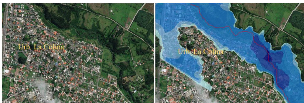
Figura 52. Zona de afectación 3, caudal 3.
