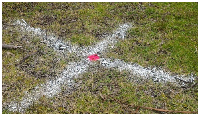
Figura 7. Marca GCP en el terreno
