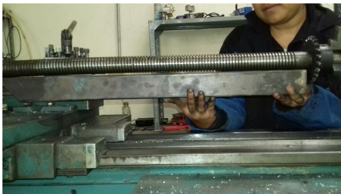
Figura 69. Prueba de dobles del tornillo de potencia
