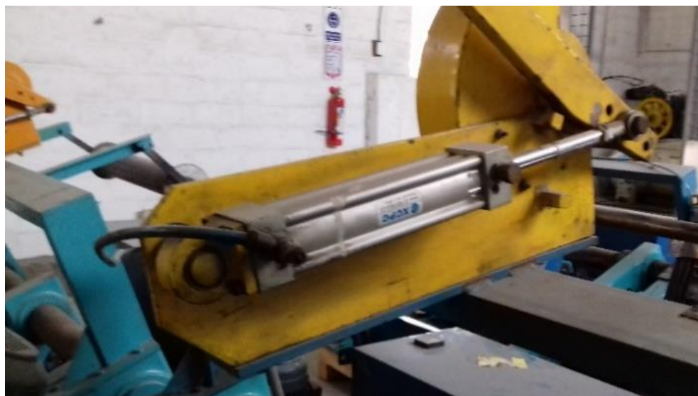
Figura 34. Cilindro Neumático 40X 150 S-LB
