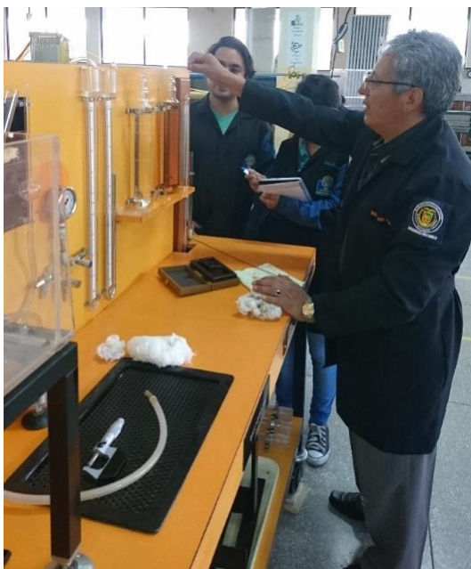
Figura 59. Medición de la velocidad de la esfera en el líquido
