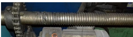
Figura 36. Tornillo de Potencia
