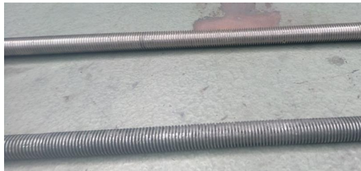
Figura 101. Reemplazo eje roscado M12
