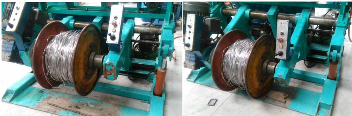
Figura 117. Sistema de Elevadores; Posición Arriba y Abajo
