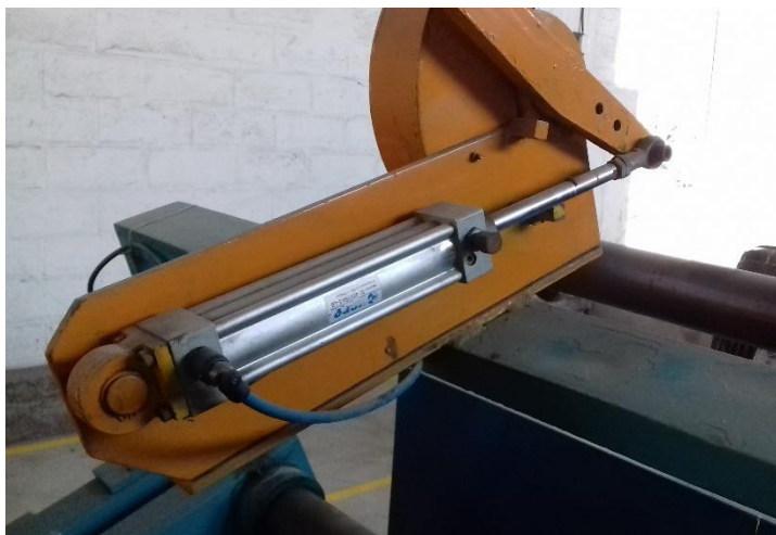
Figura 71. Cilindro neumático acoplado al Pivote
