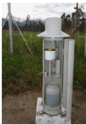
**Figura 13.** Pluviógrafo
