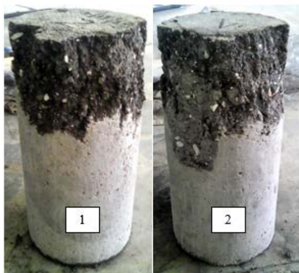
Figura 36. Planos de falla de cilindros de hormigón-edad 3 días
