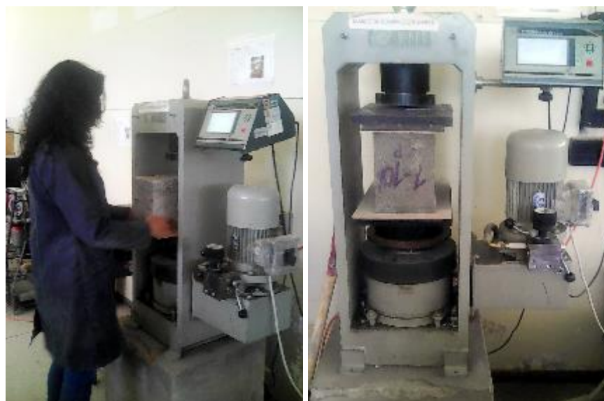
Figura 35. Colocación de bloque hueco de hormigón en la máquina de compresión
