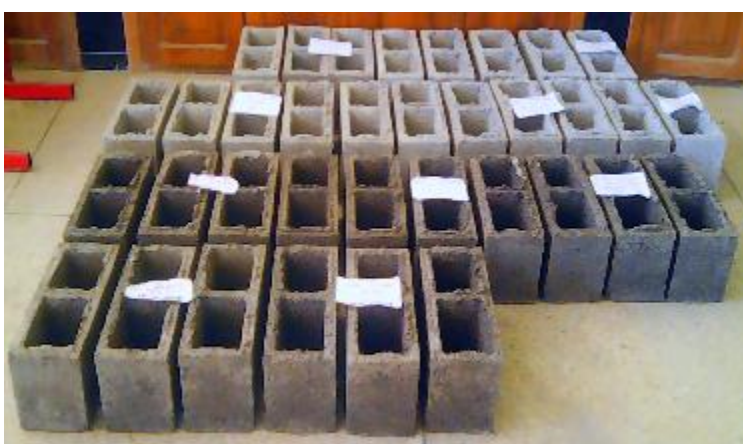
Figura 30. Proceso de curado y almacenamiento de bloques huecos de hormigón
