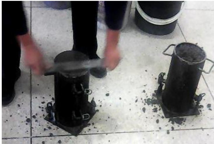
Figura 23. Proceso de enrasado del hormigón colocado en moldes cilíndricos
