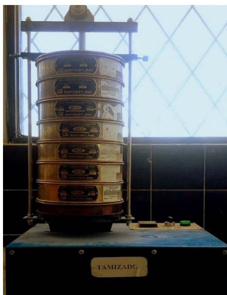
Figura 6. Tamizado de áridos para bloques huecos de hormigón
