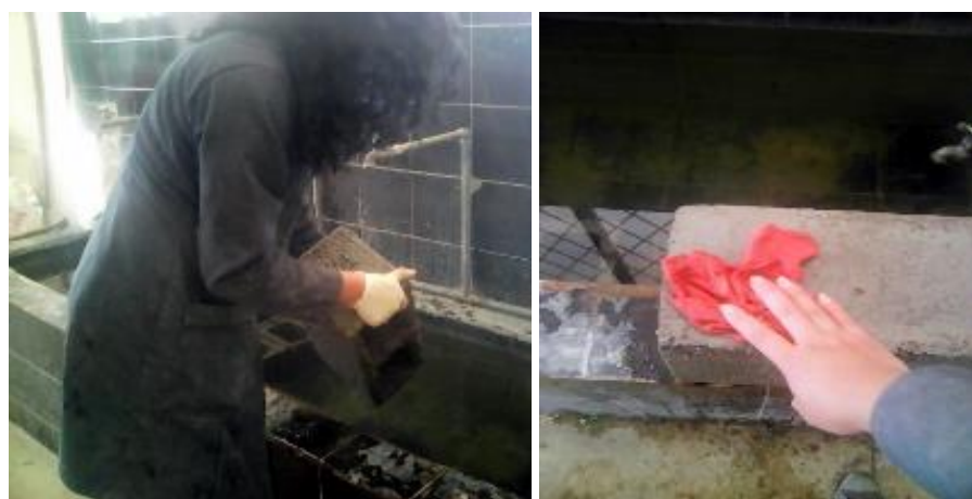
Figura 54. Secado de agua superficial de bloques huecos de hormigón
