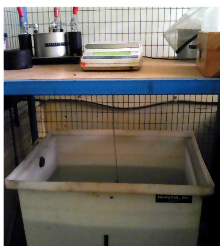
Figura 12. Equipo para ensayo densidad del plástico PET triturado
