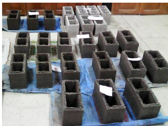
Figura 28. Proceso de endurecimiento y fraguado de bloques de hormigón
