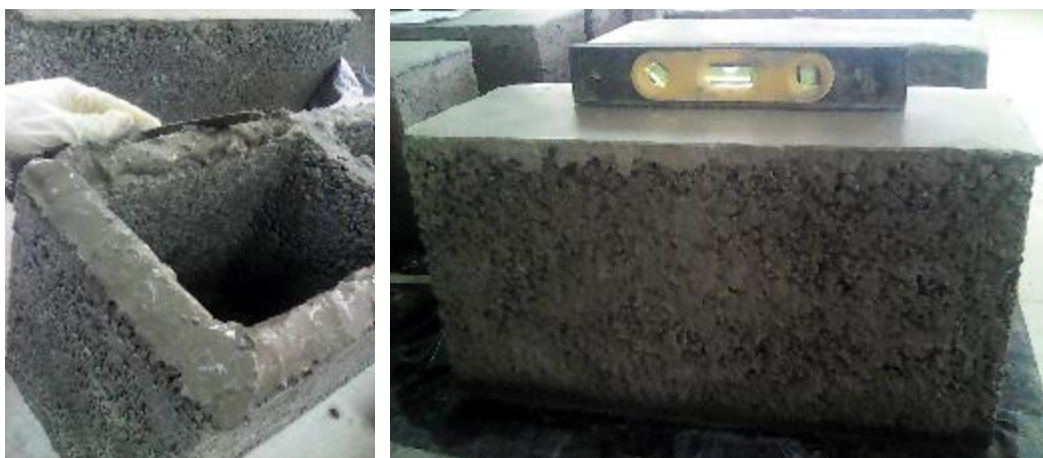
Figura 33. a) colocación de mortero en la cara superior del bloque, b) Nivelación del mortero colocado en la parte inferior del bloque
