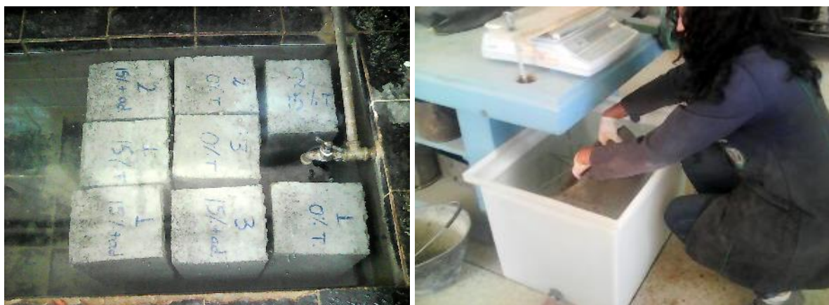
Figura 53. a) Bloques sumergidos durante 24 horas, b) Determinación de la masa sumergida de un bloque hueco de hormigón
