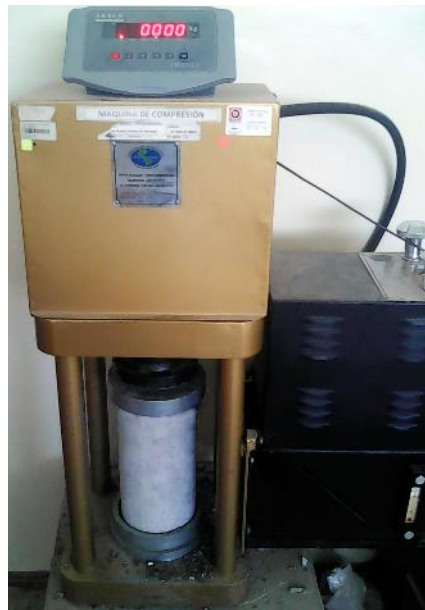
Figura 32. Ensayo a la compresión de muestras cilíndricas de hormigón
