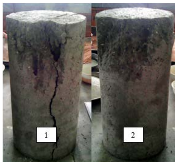
Figura 37. Planos de falla de cilindros de hormigón-edad 7 días
