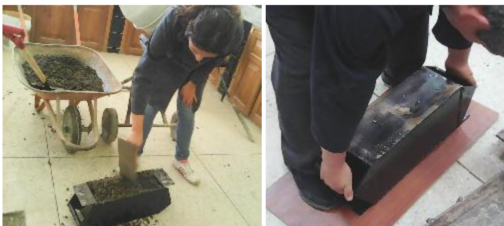
Figura 27. a) Colocación del hormigón dentro del molde, b) proceso para desmoldar los bloques de hormigón
