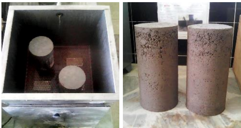
Figura 24. a) 2 cilindros en tanque de curado rápido, b) 2 cilindros dentro del laboratorio a humedad constante
