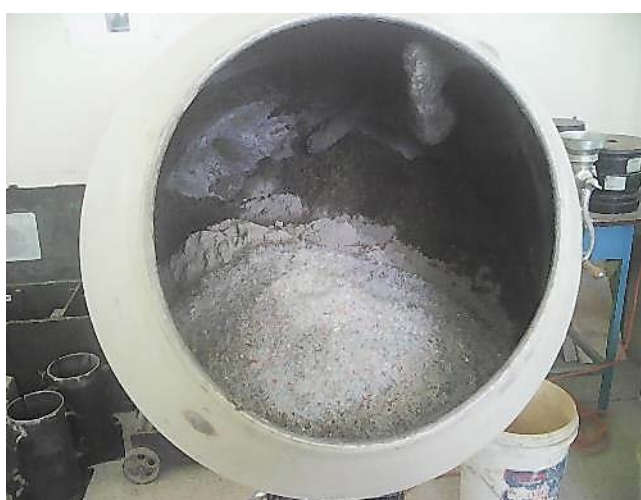
Figura 25. Colocación de los materiales para la elaboración del hormigón para bloques
