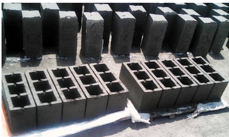
Figura 29. Proceso de curado empleado en la bloquera Alan Service ubicada en el barrio de Santa Teresa
