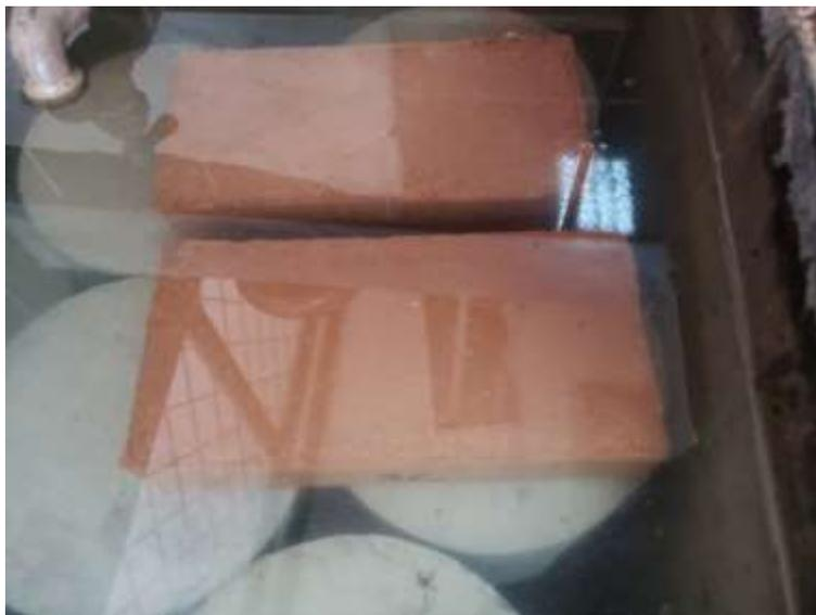
**Figura 54:** Bloques compactados sumergidos en agua
