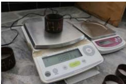
**Figura 22:** Muestra húmeda, Contenido de humedad
