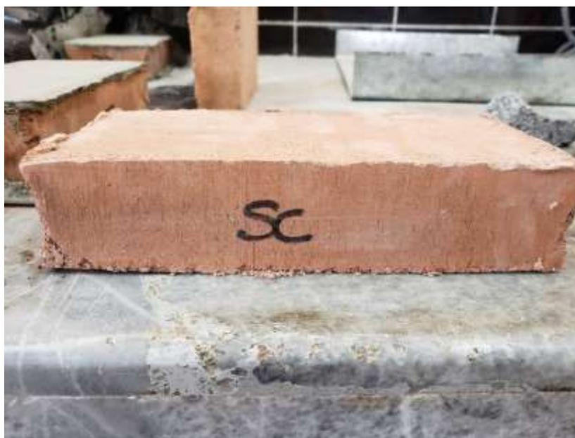
*Figura 53:* Muestra desecada en el horno por 24 horas.
