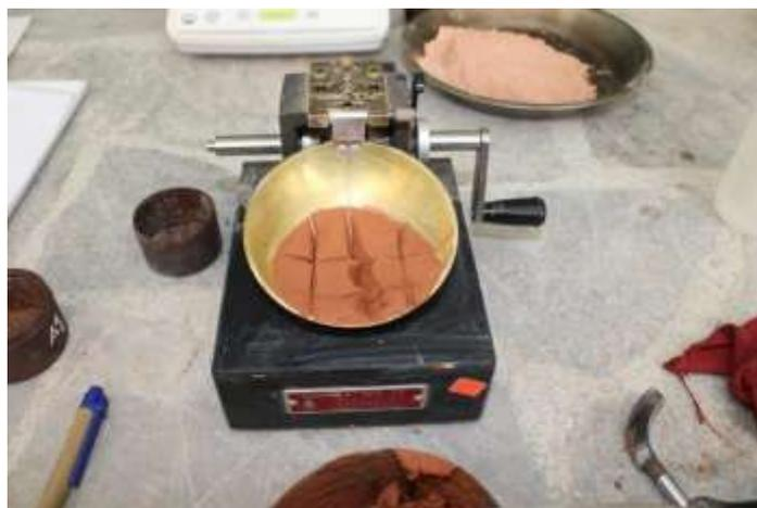
**Figura 15:** Toma de muestra para contenido de humedad
