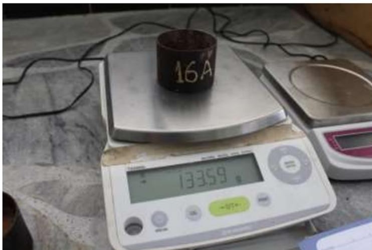
**Figura 10:** Toma de masa de muestra seca, Contenido de humedad
