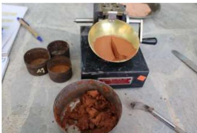
**Figura 14:** Ensayo de Limite liquido
