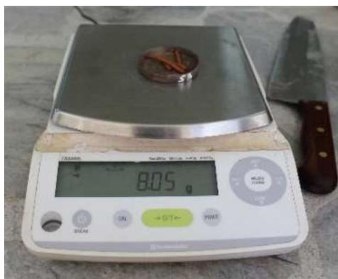
**Figura 18:** Muestra para limite plástico**Resultados**
