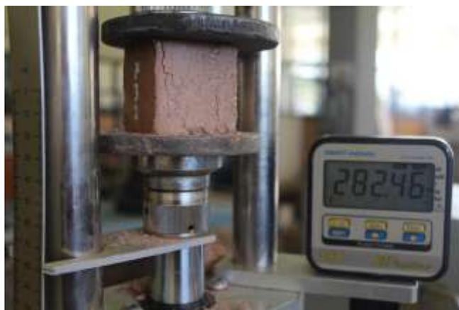
**Figura 44:** Ensayo de compresión, Dosificación Arcilla – Arena- Concha molida
