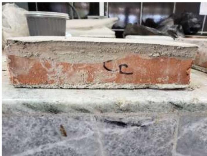
*Figura 52:* Bloque compactado refrentado
