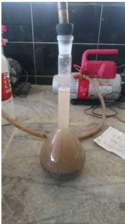
**Figura 25:** Ensayo peso específico
