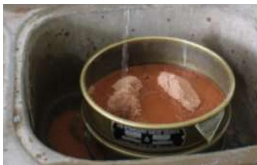
*Figura 11:* Lavado de muestra de arcilla
