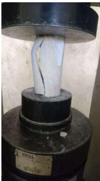
**Figura 37:** Ensayo de compresión muestra con concha de ostión
