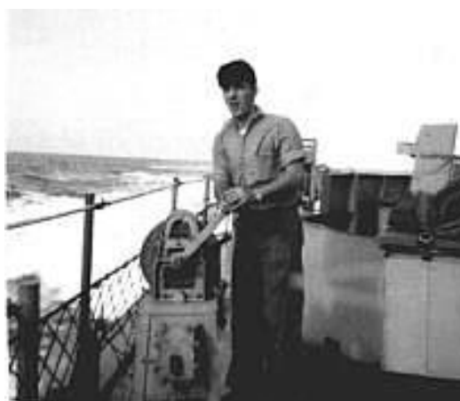
Imagen 2 Montaje de lanzamiento del batitermógrafo
