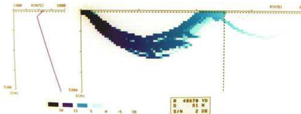
Imagen 16 Ejemplo de Predicción de Distancia Fuente: Manual de Acústica del Submarino Shyri
