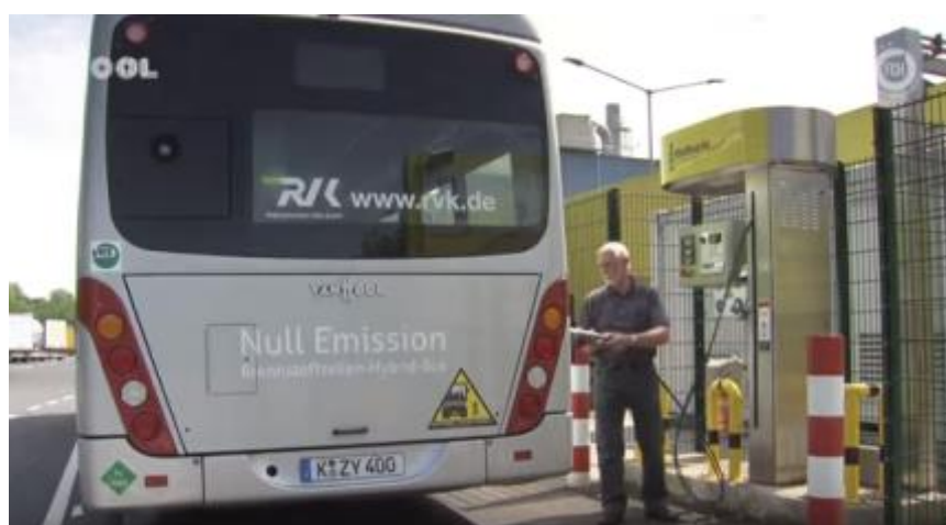
Figura 56. Suministro de hidrógeno. Fuente: (CB24, 2017)
