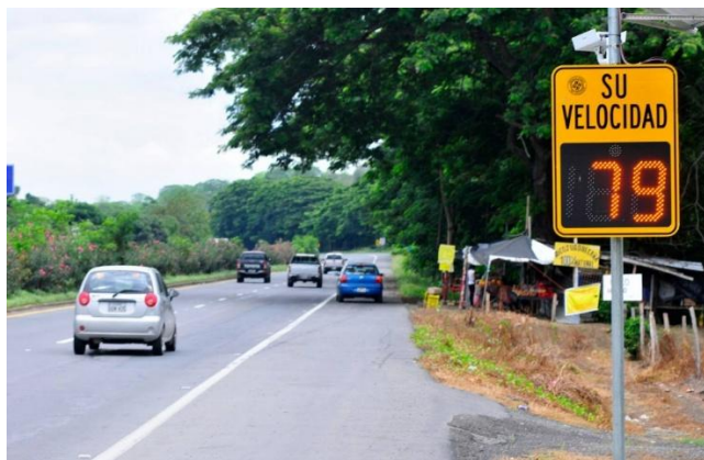
Figura 2. Radar para aviso de velocidad Fuente: (Juan Ingol Valdivieso, 2015)
