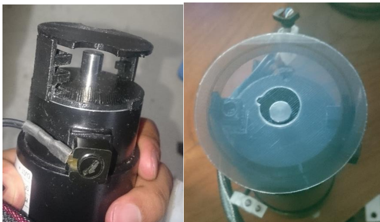
Figura 17. Encoder diseñado: Base de acople (IZQ), disco ranurado (DER).
