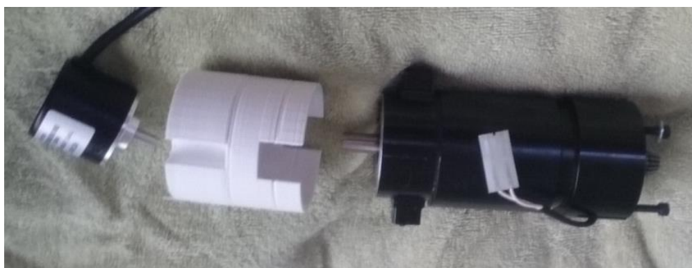
Figura 20. Base impresa para encoder adquiridos
