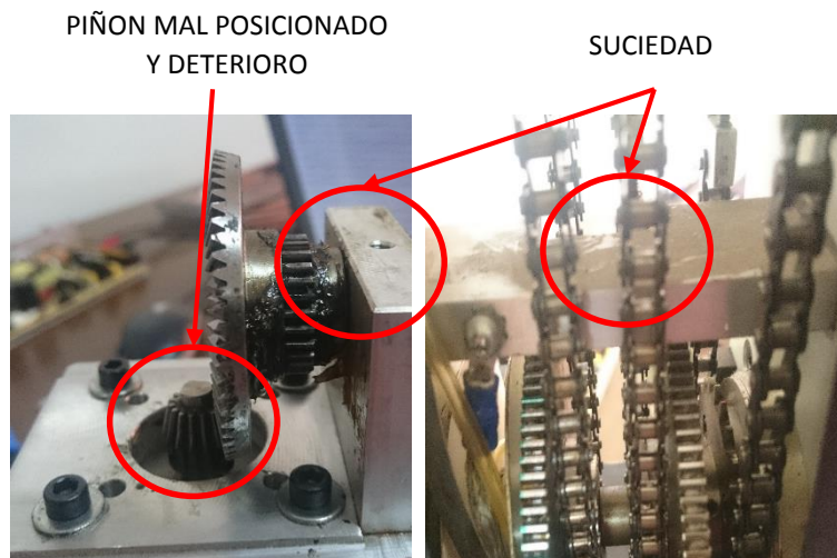
Figura 7. Problemas en la estructura.
