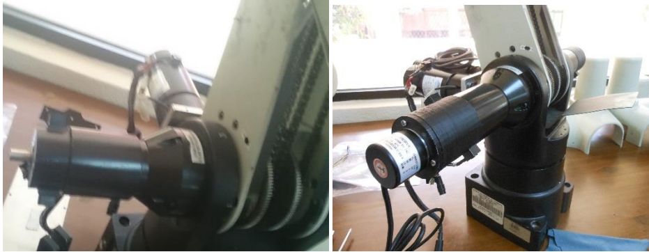
Figura 51. Estado inicial (IZQ) y estado actual (DER) de los encoders de los manipuladores CRS A255.
