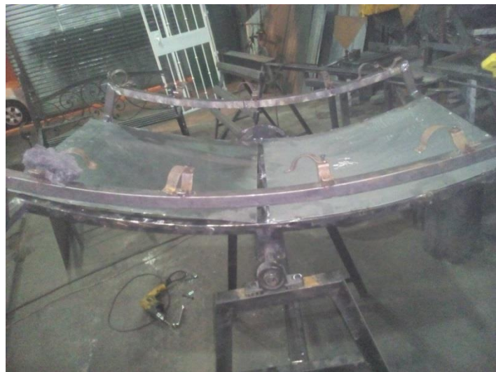
Figura 33. Base para reactor
