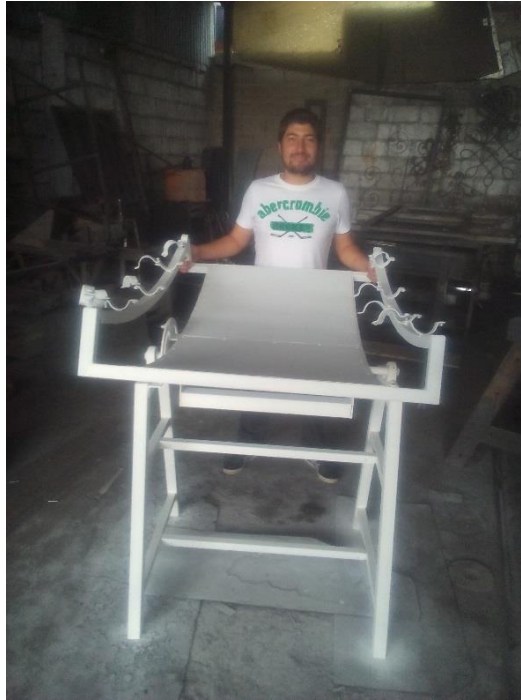
Figura 34. Base para reactor terminada
