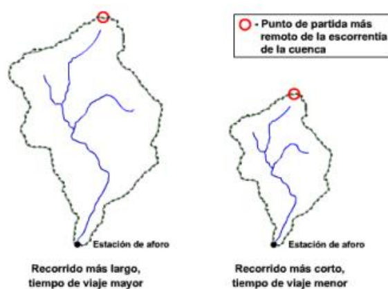
Figura 51 Efectos del tamaño de la cuenca sobre la escorrentía. Fuente: (University Corporation for Atmospheric Research, 2015, pág. 30)
