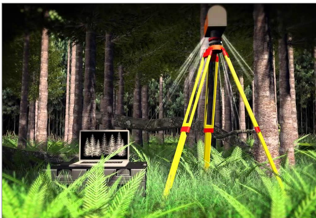
Figura 13. Escáner láser terrestre Fuente: (FPInnovations, 2012)
