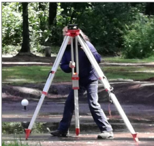
Figura 33. Nivelación del trípode
