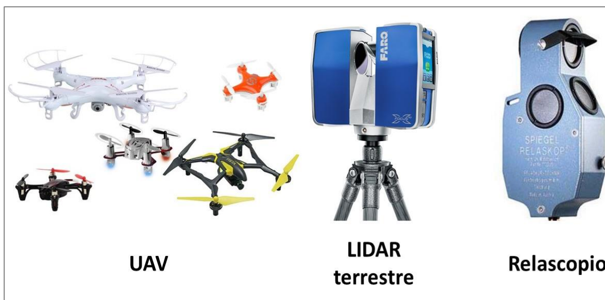
Figura 11. Equipos de mediciones indirectas Fuente: (Tech Advisor, 2018)
