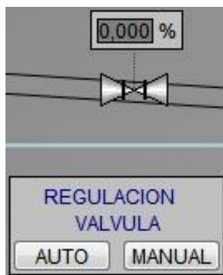
Figura 187. Regulación apertura de válvula
