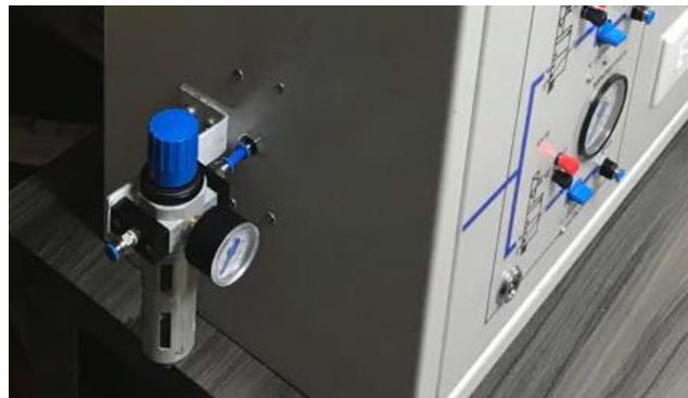
Figura 77. Unidad de mantenimiento Sistema de Entrenamiento
