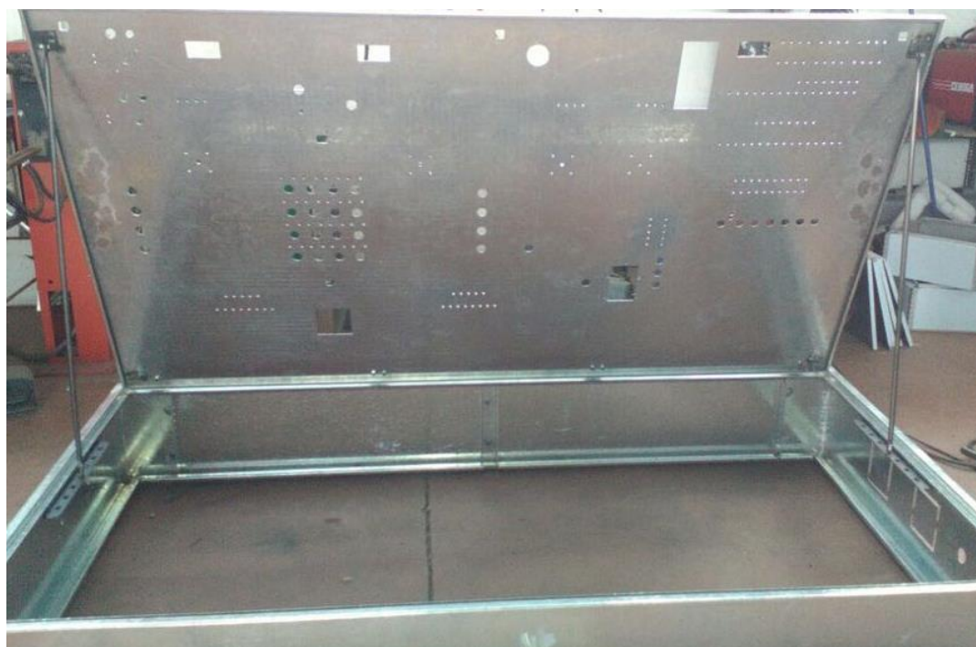
Figura 65. Perforaciones Panel Frontal Sistema de Entrenamiento
