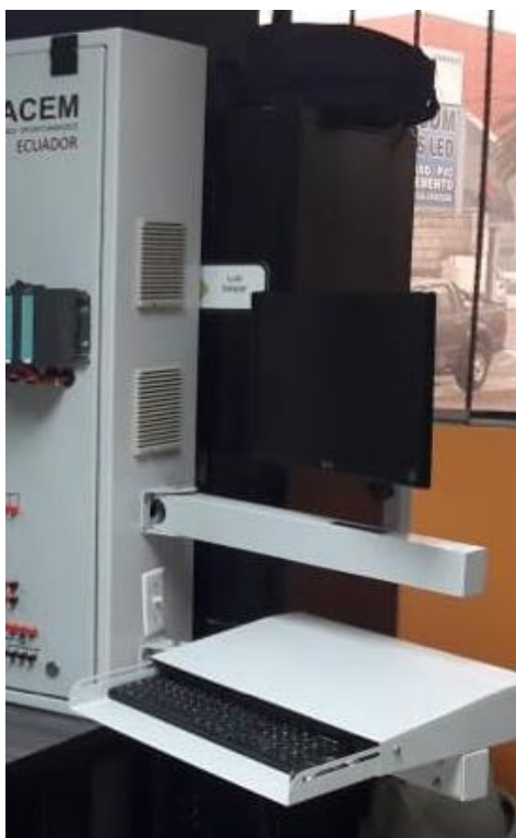
Figura 73. Ventiladores, pantalla y teclado Sistema de Entrenamiento
