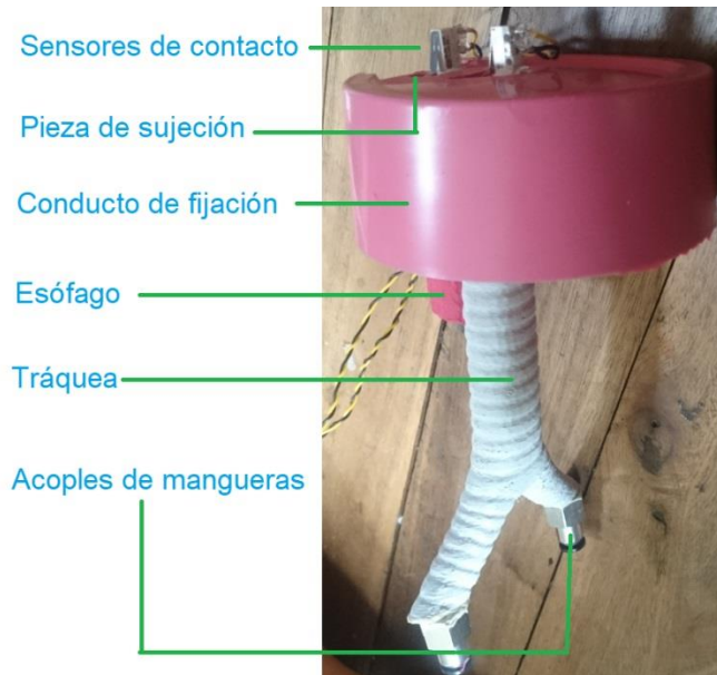
Figura 103 Conducto respiratorio ensamblado.
