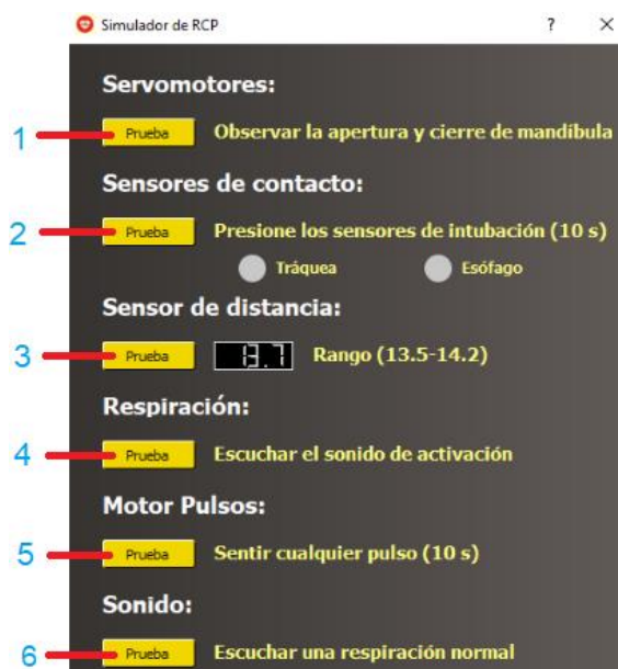
Figura 149 Prueba de sensores mediante software.
