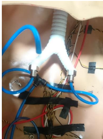
Figura 106 Cableado de las mangueras de alimentación a la tráquea.
