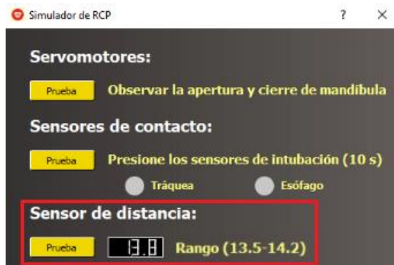
Figura 152 Verificación de funcionamiento del sensor de distancia.
