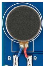
**Figura 63.** Mini motor de vibración plana
