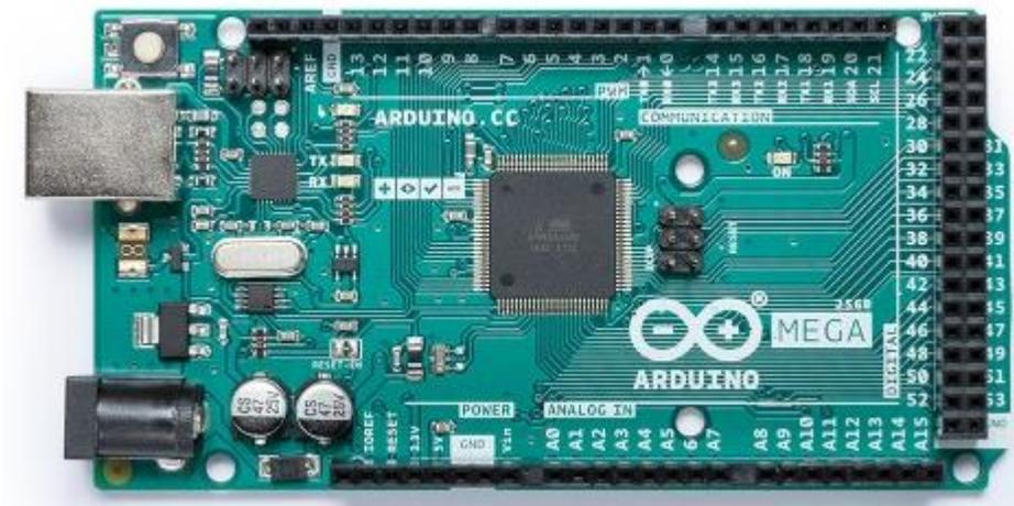
**Figura 79.** Placa Arduino Mega 2560
