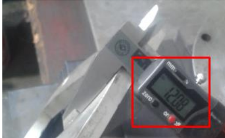
Figura 39. Medida del espesor de casco existente
