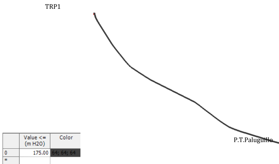
Figura 23. Sobrepresiones en la tubería (nulas) Fuente: Diseño particular
