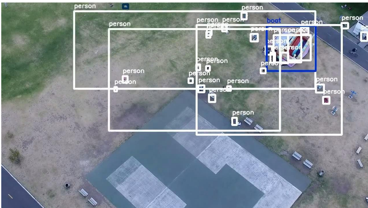
Figura 32. Detección a 60m de altura del dron con zoom, ángulo cámara 65°, frame 10
