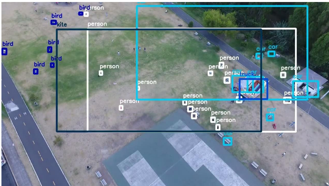
Figura 30. Detección a 40m de altura del dron, ángulo cámara 55°, frame 5
