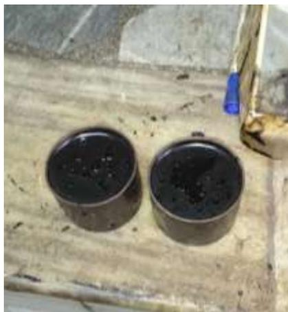
**Figura 46** Muestra para ensayo de penetración
