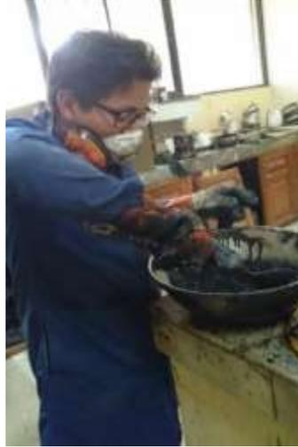
**Figura 55** Mezcla de agregados y asfalto
