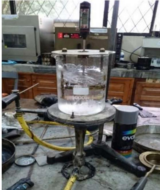
*Figura 52* Ensayo de reblandecimiento
