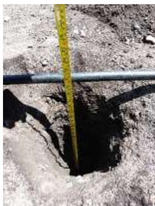
**Figura 93** Medida de las capas granulares
