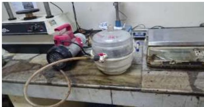
**Figura 63** Extracción de aire de muestra de asfalto
