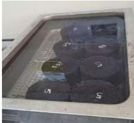
**Figura 60** Probetas en baño maría
