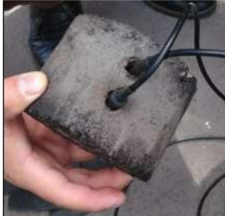
**Figura 67** Ubicación de sensores de temperatura
