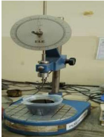
*Figura 49* Ensayo de penetración
