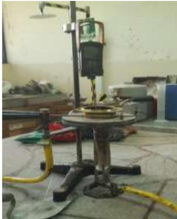
*Figura 51* Ensayo de inflamación
