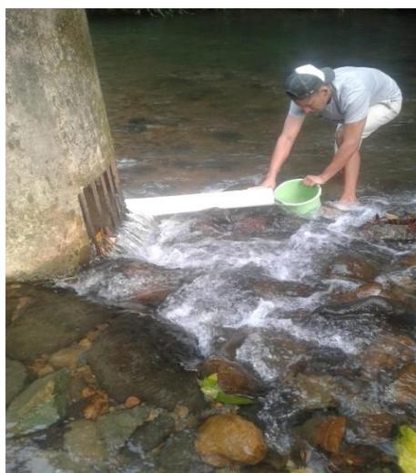
**Figura 11:** Aforo Volumétrico
