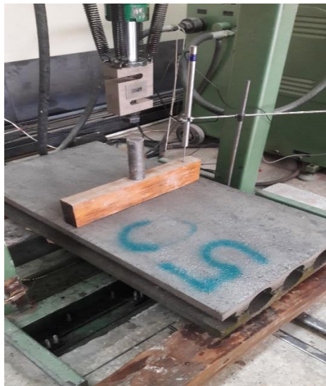
Figura 52. Panel sometido a carga puntual
