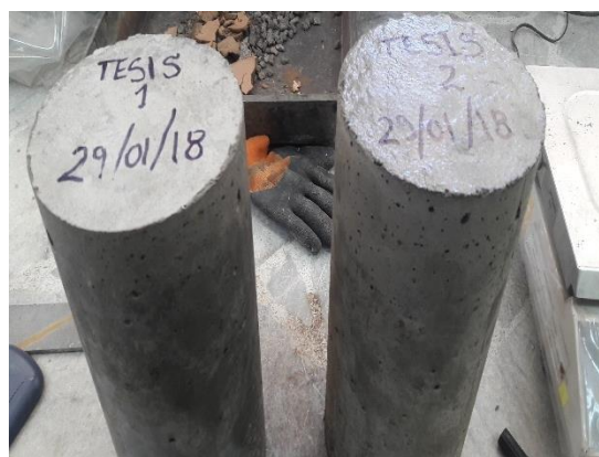
Figura 35. Cilindros de hormigón.
