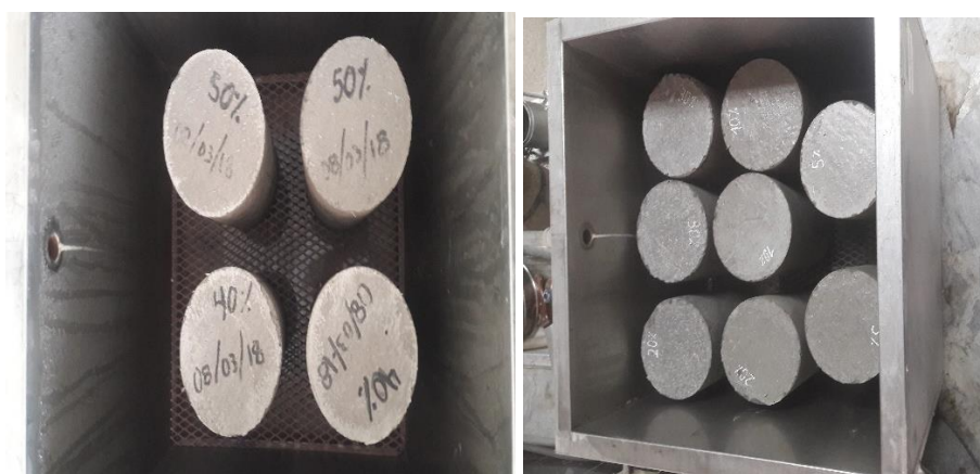
Figura 39. Curado rápido de probetas de hormigón
