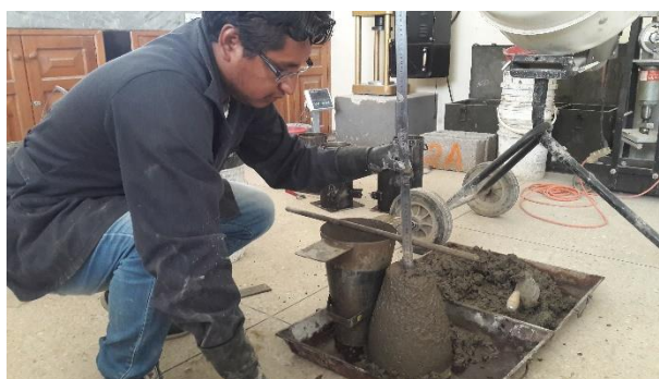
Figura 38. Medición de asentamiento
