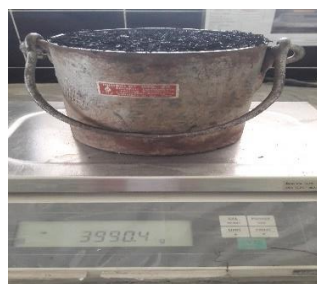
Figura 27. Ensayo densidad volumétrica del caucho.
