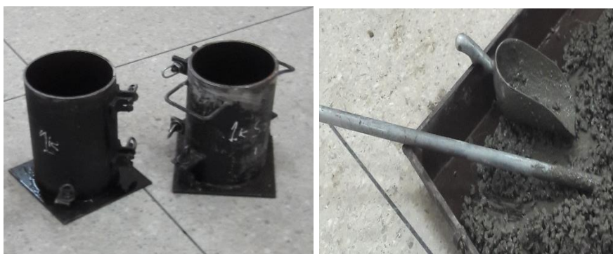
Figura 32. Equipo para elaborar especímenes. NTE INEN 1 576.
