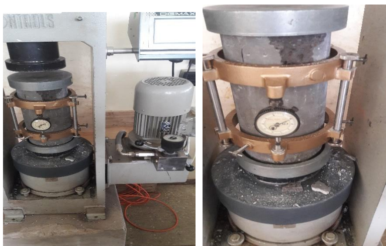
Figura 57. Ensayo para determinar el módulo de elasticidad.
