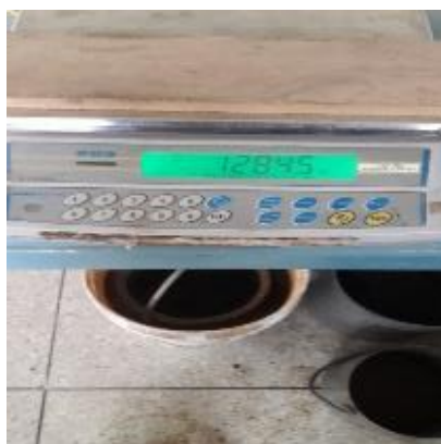
Figura 14. Masa aparente saturada en agua.
