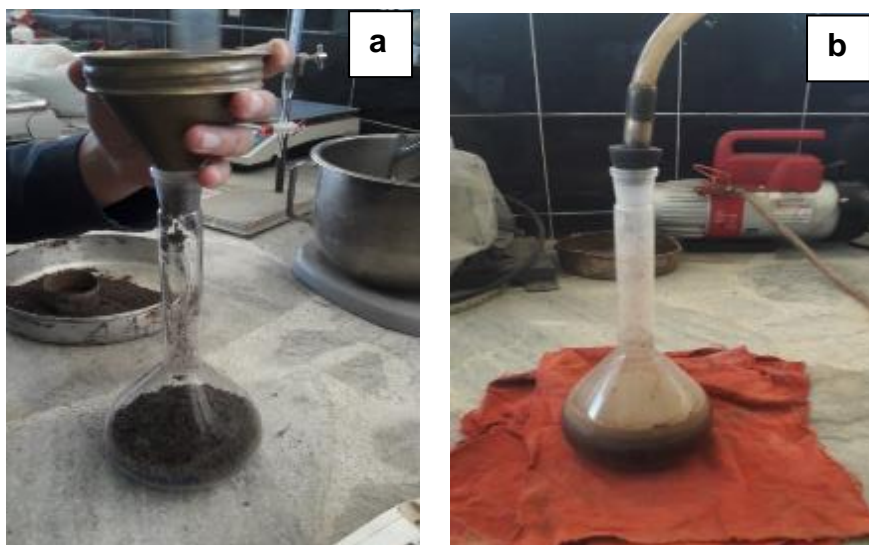
Figura 10. Adición de muestra (a), y eliminación de aire del picnómetro(b).
