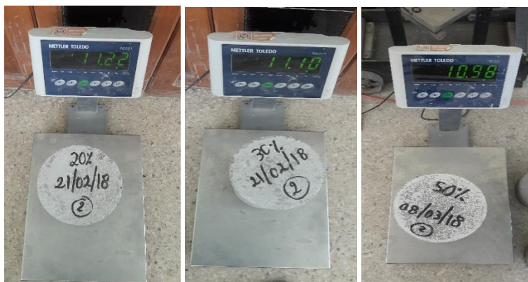
Figura 37. Cilindros de hormigón con fibra de caucho.
