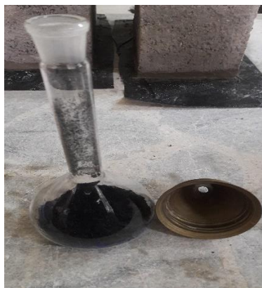
Figura 26. Ensayo gravimétrico (Densidad del caucho).
