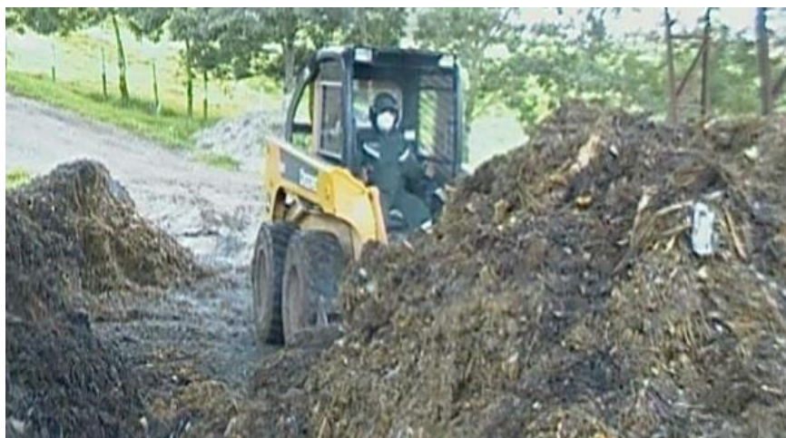
Figura 16, Volteo de la Biopila con ayuda de mini cargadora.
