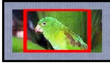
Figura 1. 27. Primer método para la conversión 16:9 HDTV/DTV al formato 4:3
