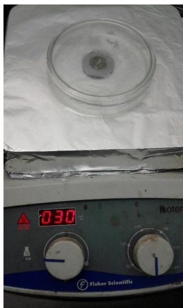
Figura 6. Depósito de muestras en el portaobjetos para su posterior XRD
