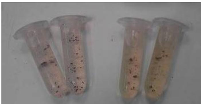
**Figura 18.** Ensayos de síntesis de nanocompuestos de paladio y óxido de grafeno reducido, post lavado del producto a pH12.
