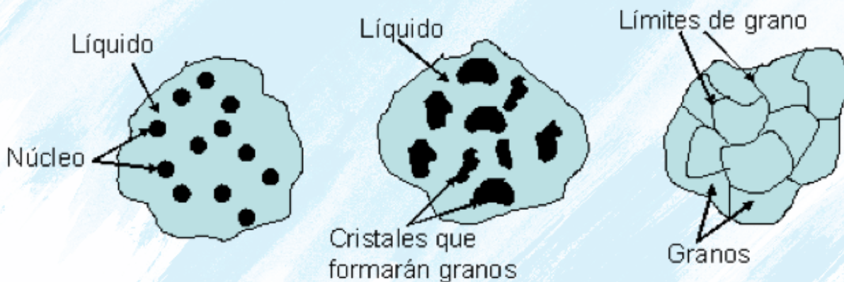
Figura 39 Fases del metal durante la solidificación Ilustración. (Baralt, 2016)
