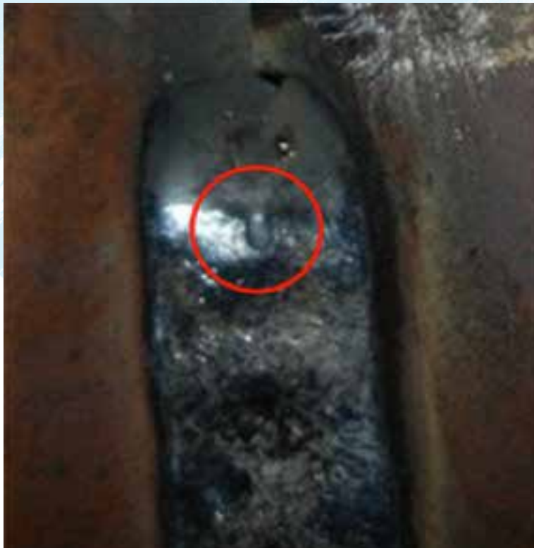
Figura 38 Grieta en el terminal de un cráter. X100 Ilustración. Héctor Terán
