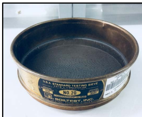
Figura 16. Tamiz N. 20 para la homogenización de partículas
