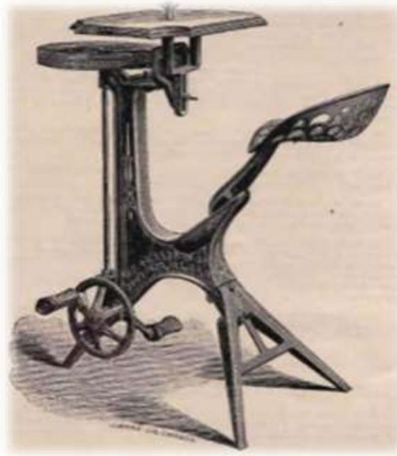
Figura 3. Fresa accionada por pedal
