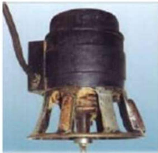
Figura 4. Router Eléctrico Kelley
