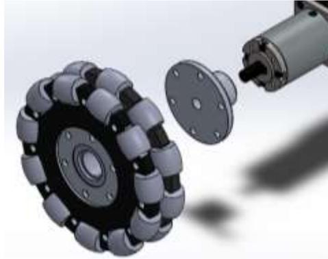
Figura 41. Ensamble rueda omnidireccional
