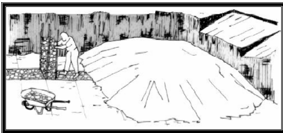
Figura 5.4: Elevación gradual de las chimeneas para gases.
