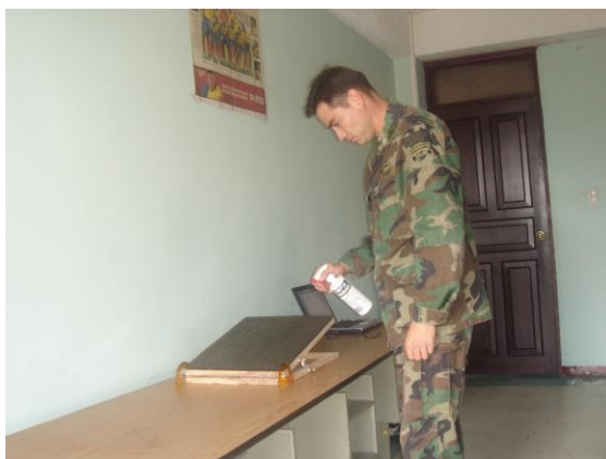
Fotografía 4.1: Simulación de lluvia con la máquina de pendientes.
