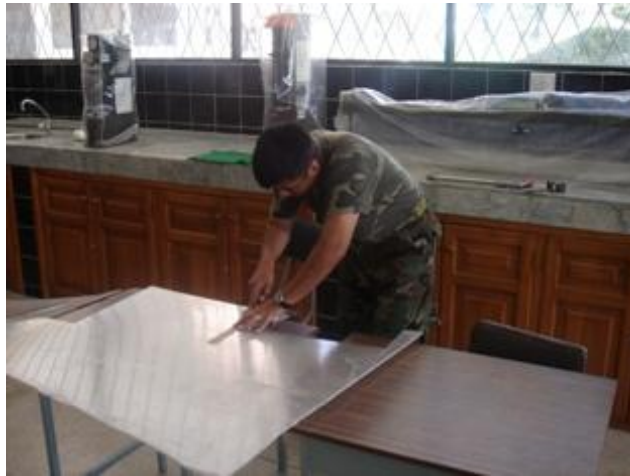
Fotografía 3.1: Preparación de las muestras de policarbonato.
