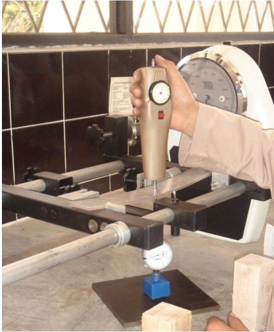
Fotografía 3.9: Máquina para ensayo de vigas.
