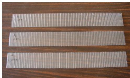
Fotografía 3.8: Muestras para el ensayo de flexión transversal.
