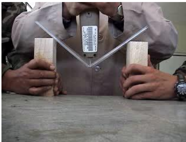
Fotografía 3.10: Falla de las muestras a flexión.
