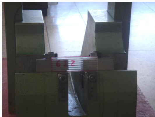
Fotografía 3.13: Muestra colocada para el ensayo de impacto.
