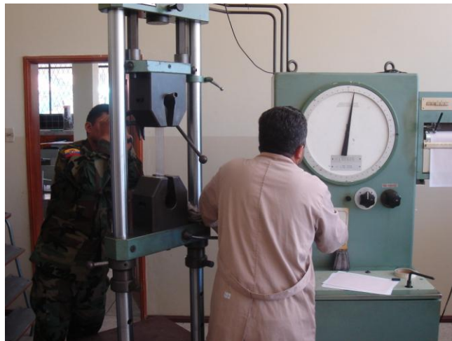
Fotografía 3.6: Muestra colocada para el ensayo de tracción.
