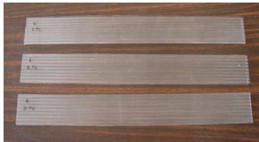
Fotografía 3.7: Muestras para el ensayo de flexión longitudinal.
