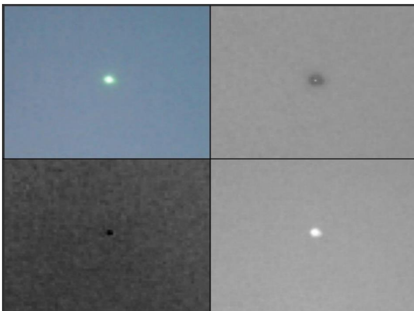
Figura 35. Superior Izquierda: imagen original, Superior Derecha: matriz Hue, Inferior Izquierda: matriz Saturation, Inferior Derecha: matriz Value.
