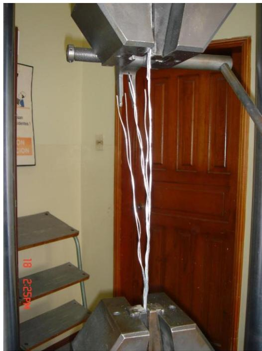
**Figura 2.13:** Falla de la probeta al aplicar la fuerza constante.
