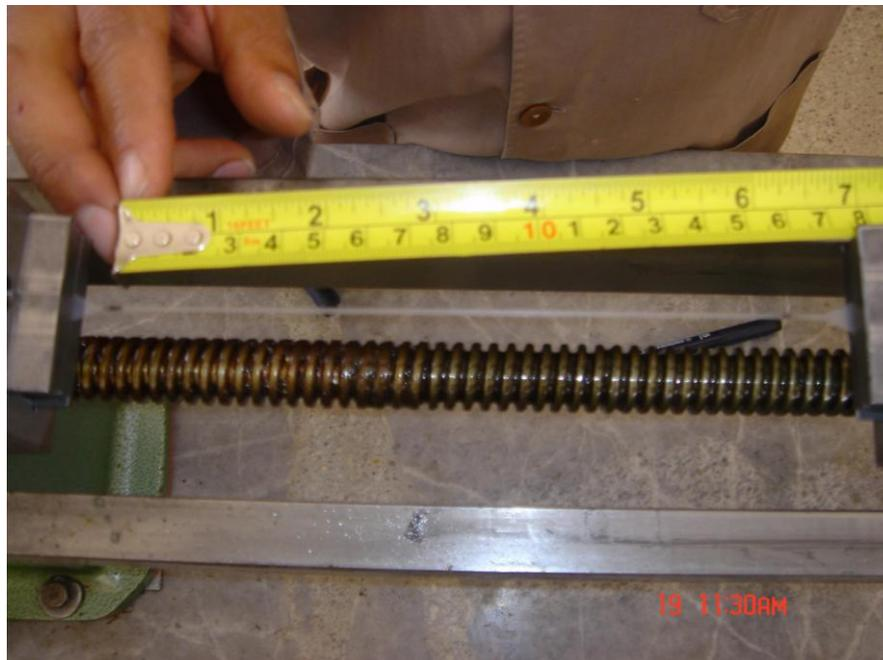
**Figura 2.34:** Medición de la probeta conforme su alargamiento.
