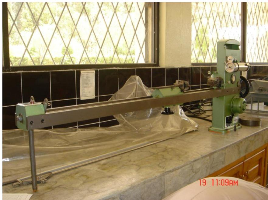
**Figura 2.30:** Máquina de Tracción Horizontal "AMSLER".
