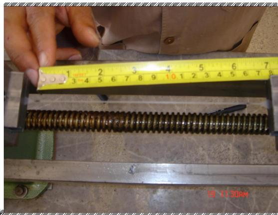
**Figura 6.3:** Alargamiento de la probeta de polietileno.
