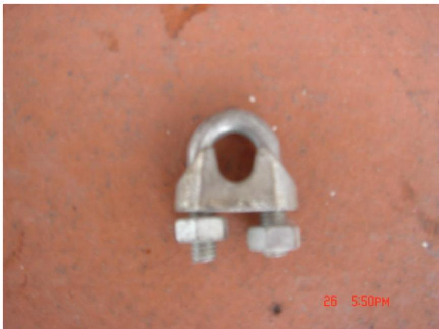
**Figura 5.38:** Grillete para sujeción del cable de acero.
