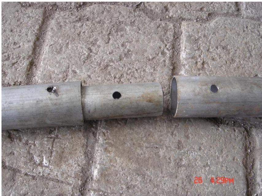
**Figura 5.30:** Bocines de los componentes de la cercha.
