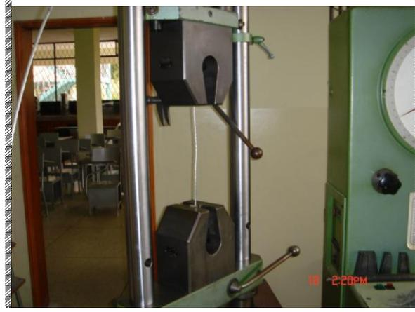
**Figura 6.2:** Cable de acero en la maquina Universal.
