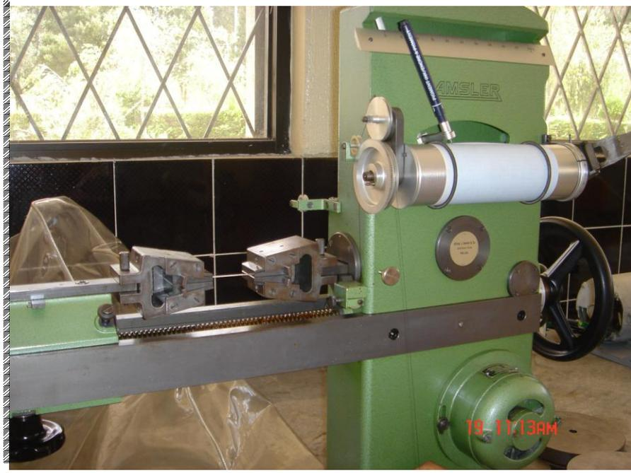
**Figura 2.33:** Aplicación de la tracción a la probeta.
