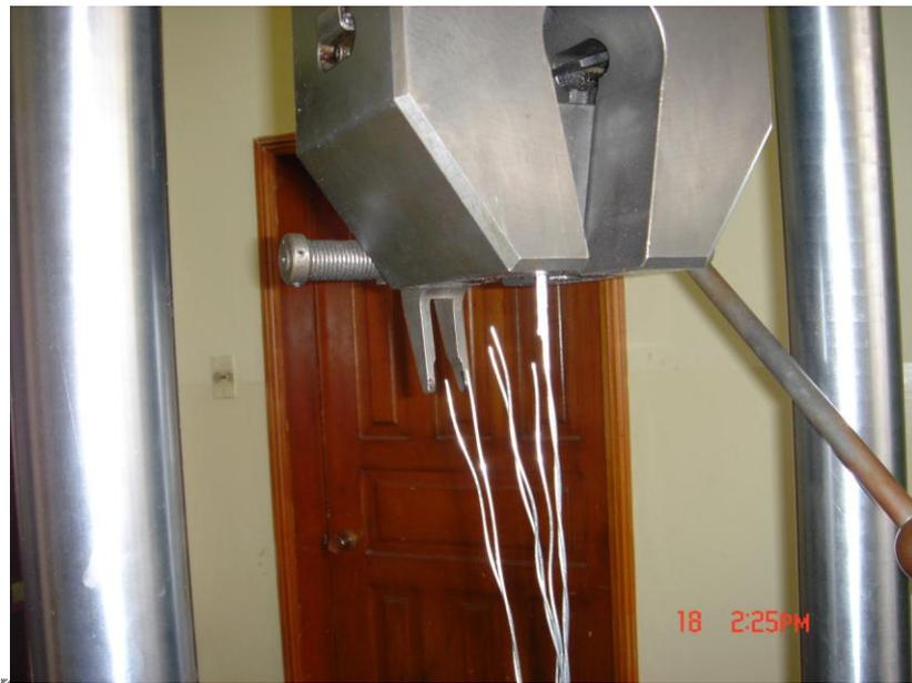
**Figura 2.14:** Falla de la probeta al aplicar la fuerza constante.
