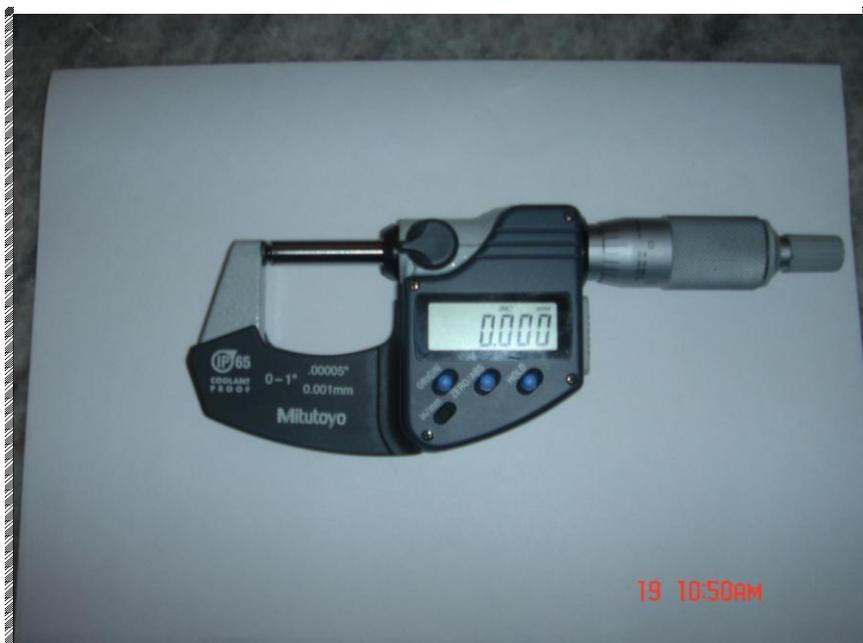
**Figura 2.28:** Micrómetro para medir espesores.
