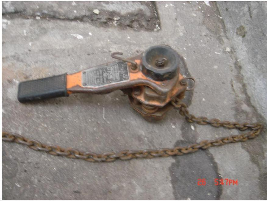
**Figura 5.35:** Tacle para tensar los cables con 300 kg.
