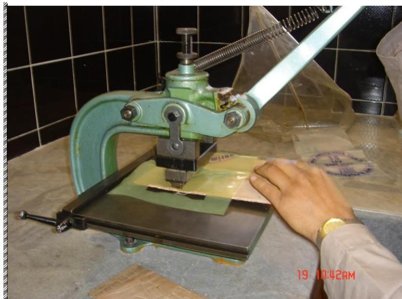
Figura 2.26: Obtención de las probetas por medio de la troqueladora.
