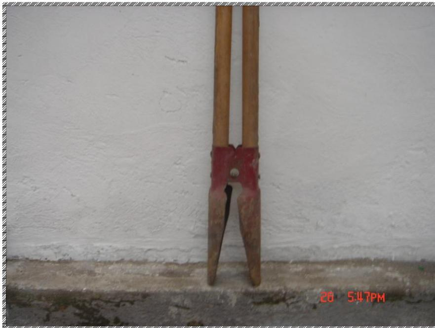
**Figura 5.36:** Holladora para realizar huecos en la superficie y colocar las estacas.
