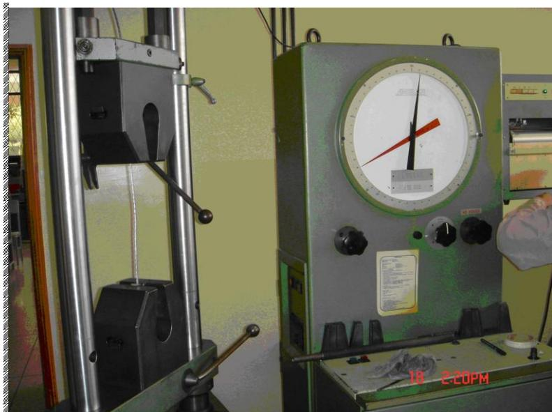
**Figura 2.11:** Equipo de Ensayos Universales “AMSLEER”.
