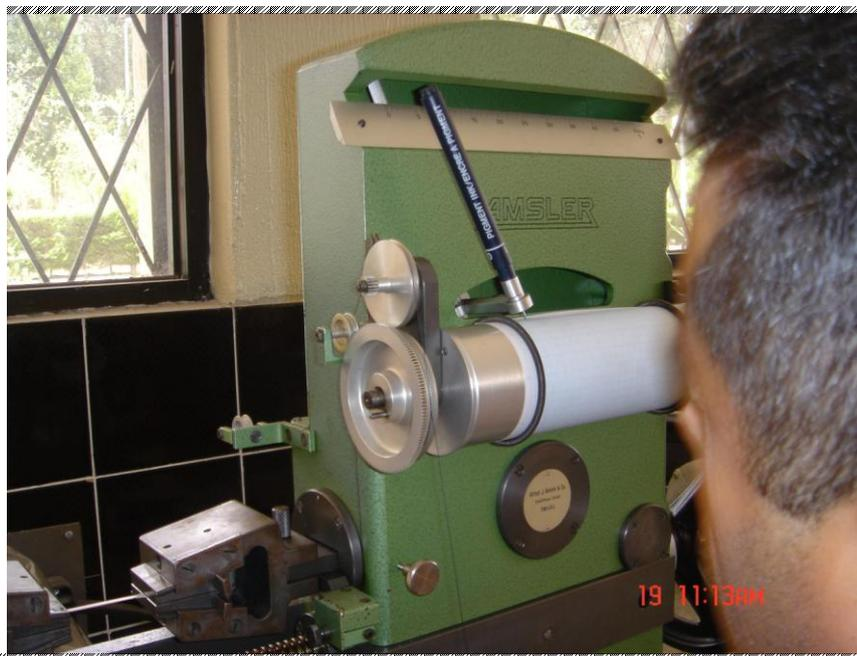
**Figura 2.32:** Obtención de la curva esfuerzo-deformación.
