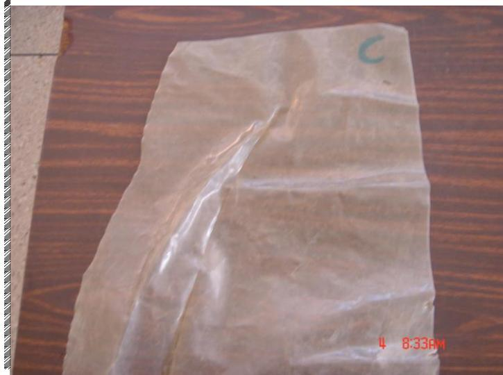
**Figura 2.43:** Muestra de polietileno de 1 año.
