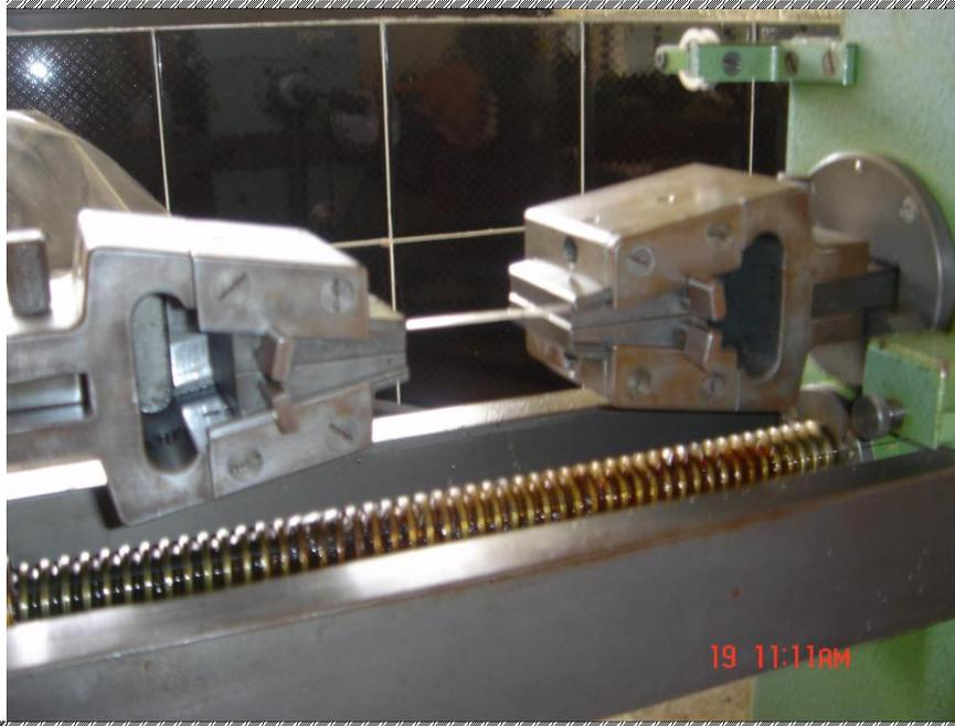
**Figura 2.31:** Probeta puesta en las mordazas.
