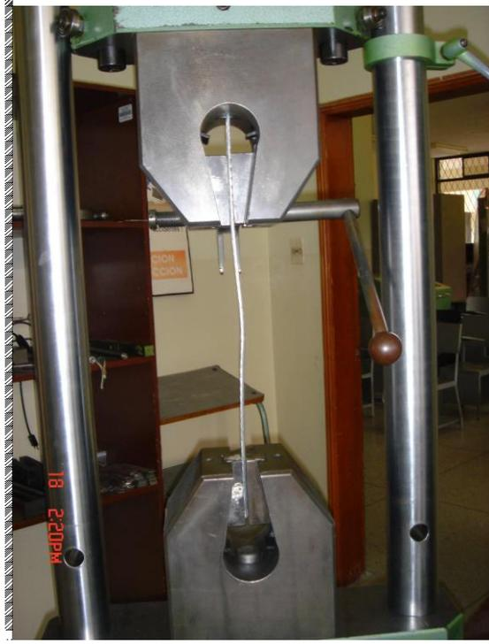
**Figura 2.12:** Colocación de la Probeta en las mordazas.
