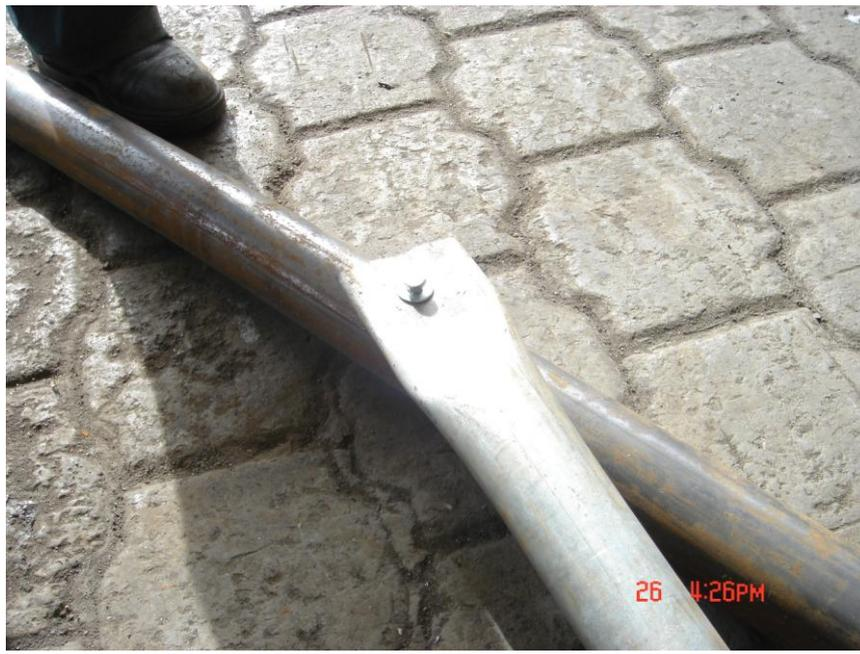
**Figura 5.31:** Unión del tubo troquelado a la cubierta.
