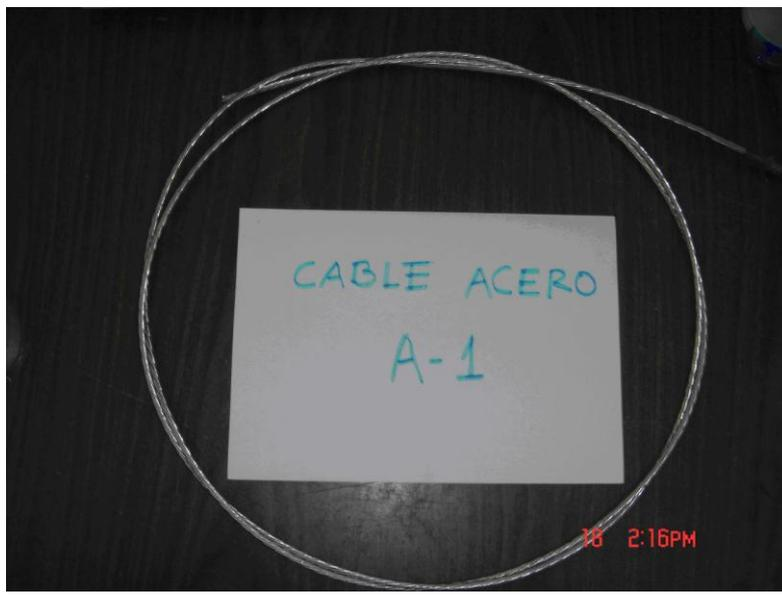
**Figura 2.10:** Cable a ser ensayado.
