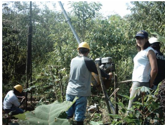
Fotografías N° 4.3 y 4.4: Ensayo de Penetración Standard (SPT)
