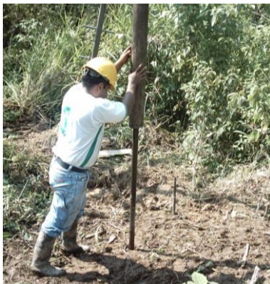
Fotografías N° 4.3 y 4.4: Ensayo de Penetración Standard (SPT)
